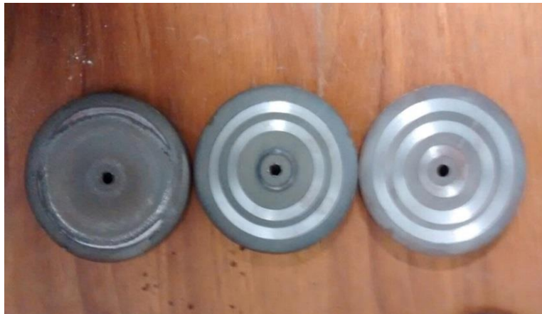
Figura 28. Huellas sobre las probetas después de ser sometidas a ensayos de desgaste adhesivo
