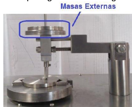
Figura 19. Masas externas requeridas para garantizar la carga recomendada en el ensayo
