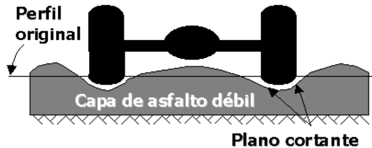
Figura 10. Ahuellamiento por Fallas en la Mezcla Asfáltica
