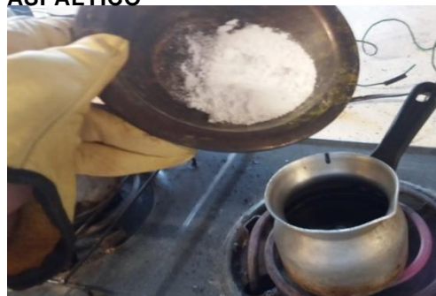
FOTOGRAFÍA 53. P.V.C. SIENDO AGREGADO AL CEMENTO ASFÁLTICO
