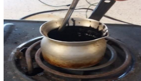
FOTOGRAFÍA 58. MEZCLA DE CEMENTO ASFÁLTICO
