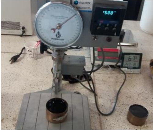
FOTOGRAFÍA 8. ENSAYO DE PENETRACIÓN
