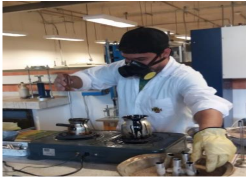
FOTOGRAFÍA 51. OPERARIO REALIZANDO LA MEZCLA DEL CEMENTO ASFÁLTICO
