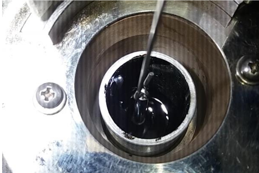
FOTOGRAFÍA 73. HOMBRO CUBIERTO POR CEMENTO ASFÁLTICO.
