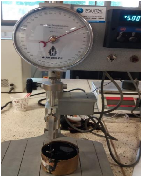
FOTOGRAFÍA 10. ENSAYO PENETRACIÓN REALIZADO
