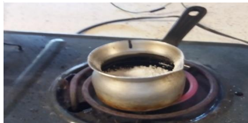
FOTOGRAFÍA 60. CEMENTO ASFÁLTICO CON P.V.C. RECIÉN AGREGADO
