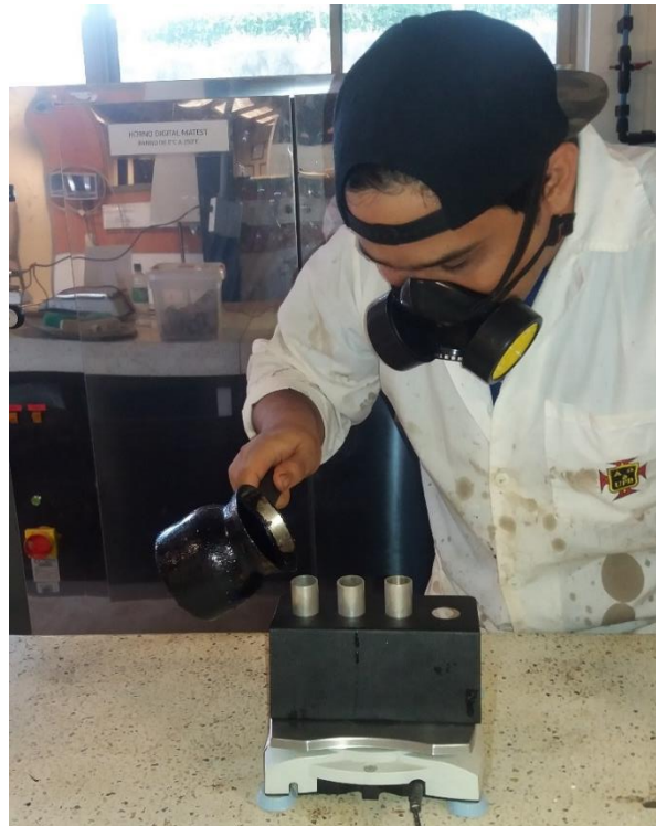
FOTOGRAFÍA 39. CEMENTO ASFÁLTICO SIENDO VERTIDO EN CAPSULA.
