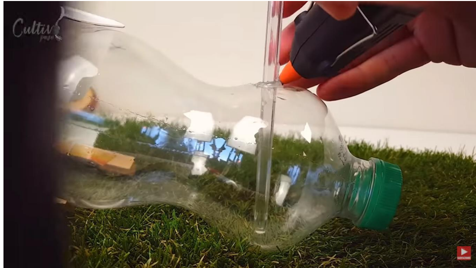
Figura 14. Muestra la fijación del tubo que funcionará como sistema de ventilación del sistema.
