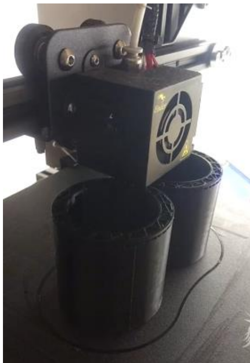
Figura 82. Proceso de construcción de la cesta de plantación.
