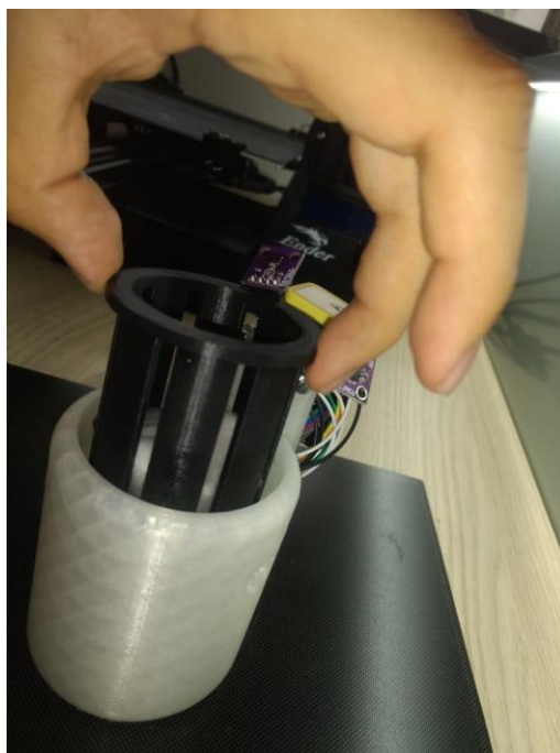
Figura 84. Proceso de integración entre la cesta de plantación y el contenedor de agua.
