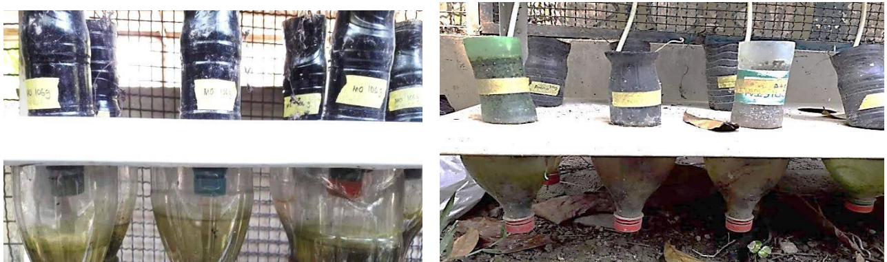
Figura 12. Sistema de recolección del lixiviado Fuente: Elaboración propia
