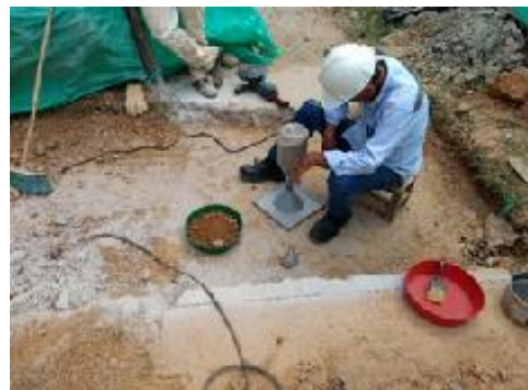
Figura 26. Vaciado de arena ensayo de densidad de cono
