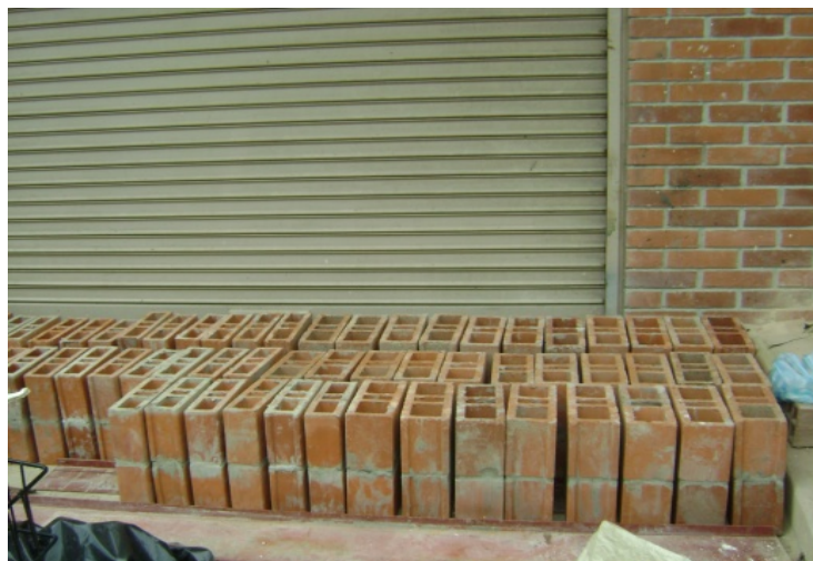
Figura 25. Curado de los muretes 28 días.
