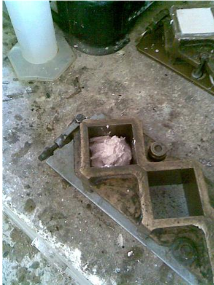
Figura 3. Llenado de moldes.
