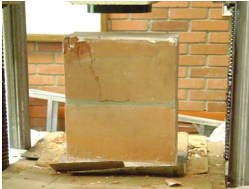
Figura 28. Tipo de fallas presentadas en los muretes.
