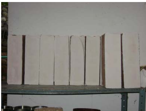
Figura 14. Piezas Refrentadas y Ordenadas.
