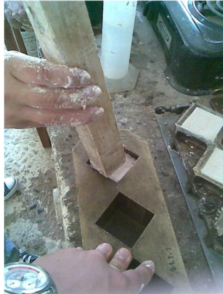
Figura 3. Llenado de moldes.
