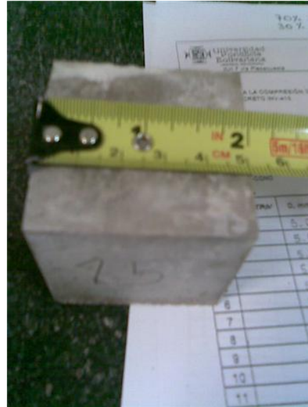
Figura 7. Toma de medidas de las muestras.
