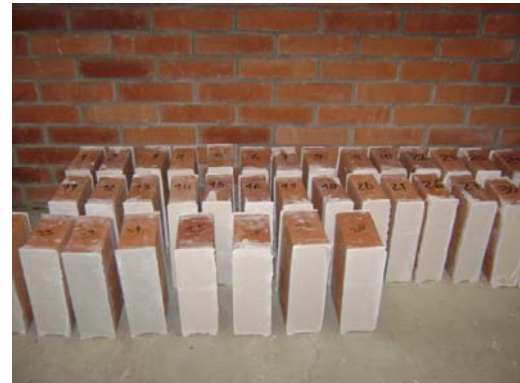
Figura 14. Piezas Refrentadas y Ordenadas.
