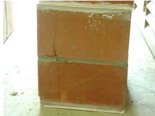
Figura 28. Tipo de fallas presentadas en los muretes.
