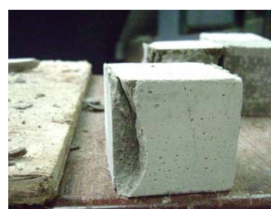
Figura 19. Resistencia a la compresión de las muestras del mortero.
