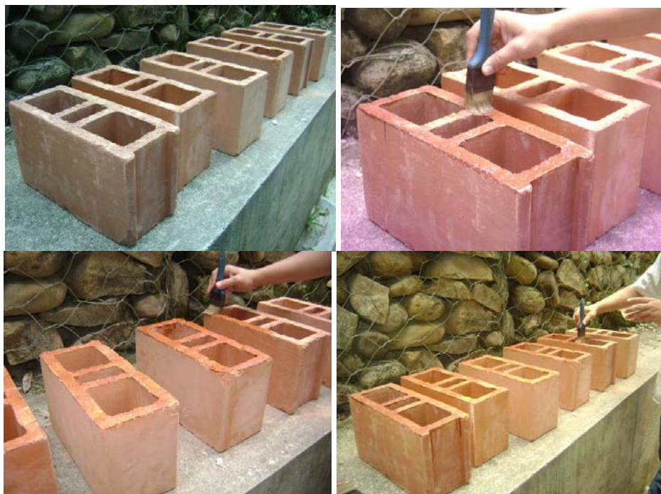
Figura 10. Aplicación de Laca a las caras de las Unidades.
