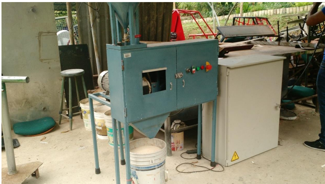
Figura 14. Maquinaria para la prueba de desgaste abrasivo
