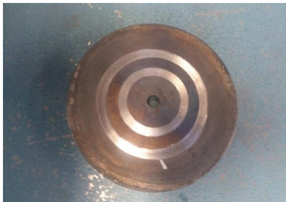
Figura 20. Ensayo de resistencia al desgaste adhesivo
