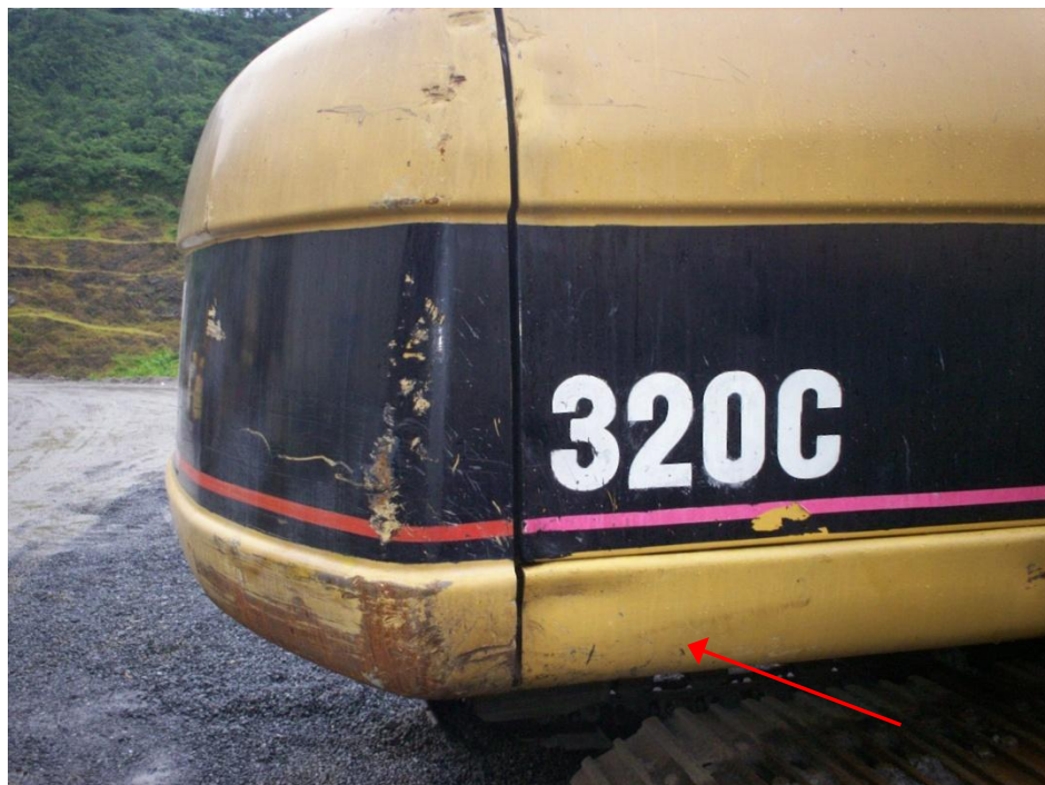
Estructura afectada por diferentes golpes
