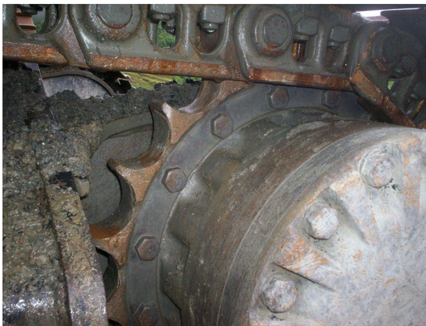
Sprocket con desgaste acentuado
