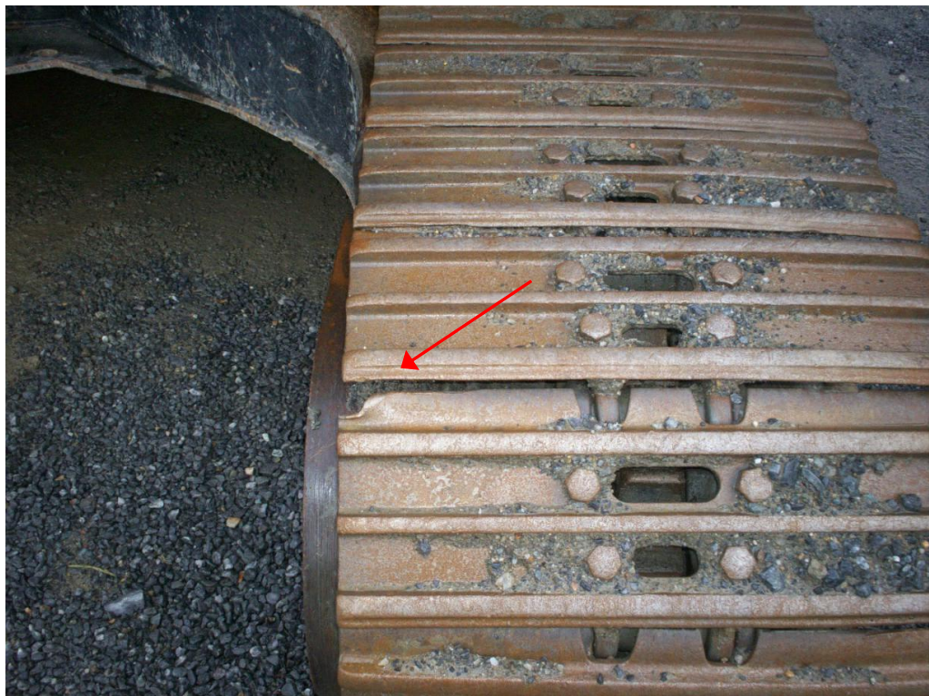
Material rodante con desgaste pronunciado.
