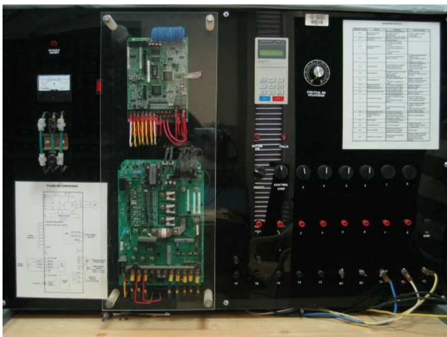
Figura 12. Variador de Velocidad Yaskawa 616G5 1
