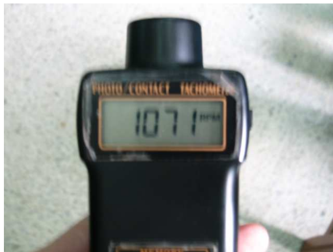
Figura 46. Velocidad del Motor dada por el Tacómetro Manual 2
