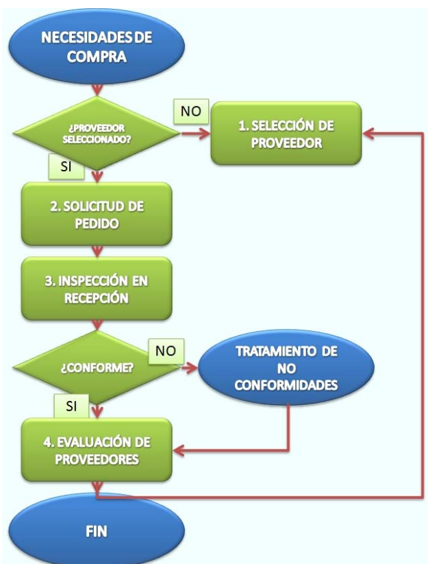
Imagen 5. Diagrama del proceso de compras según ISO 9001
