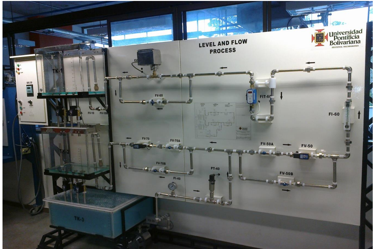
FIGURA 7. Planta de Nivel y Flujo.
