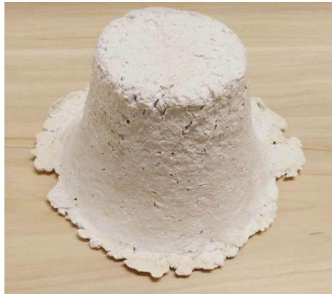
Figura 4. Recipiente moldeado obtenido a partir de la mezcla de celulosa y agua, licuada por un minuto. Fuente: Fotografía del autor.
