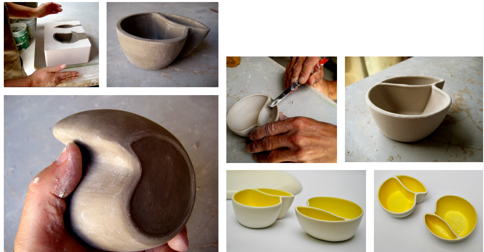
Figuras 36 a la 42. Prototipos del proyecto Caracola, contruidos a través del proceso de moldeo por colada de cerámicos. Fuente: Diseño y fotografías del autor.
