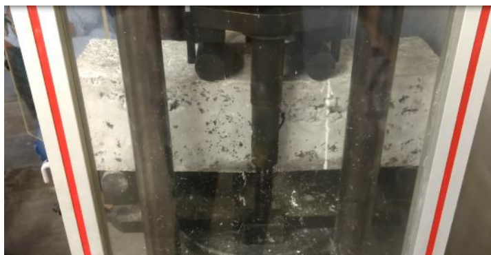
Ilustración 39. Fallo viga con botellas en maquina
