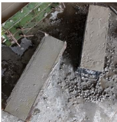
Terminación de las dos (2) vigas a fallar a flexión a los 28 días
