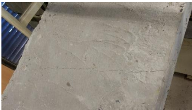
Ilustración 45. Falla superior placa con botella
