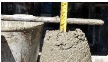
Ilustración 23. Asentamiento Normal. 2.9cm
