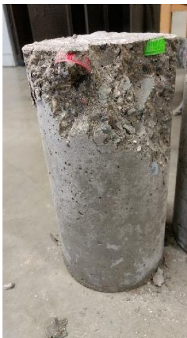
Ilustración 34. Fallo de tapas plásticas
