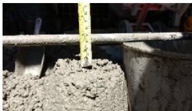
Ilustración 24. Asentamiento de Botellas. 3.5cm
