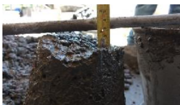
Ilustración 25. Asentamiento con Tapas. 2.7cm
