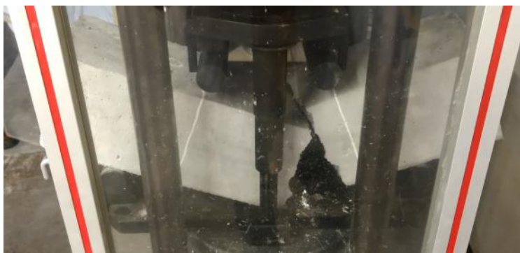
Ilustración 38. Fallo viga normal en maquina
