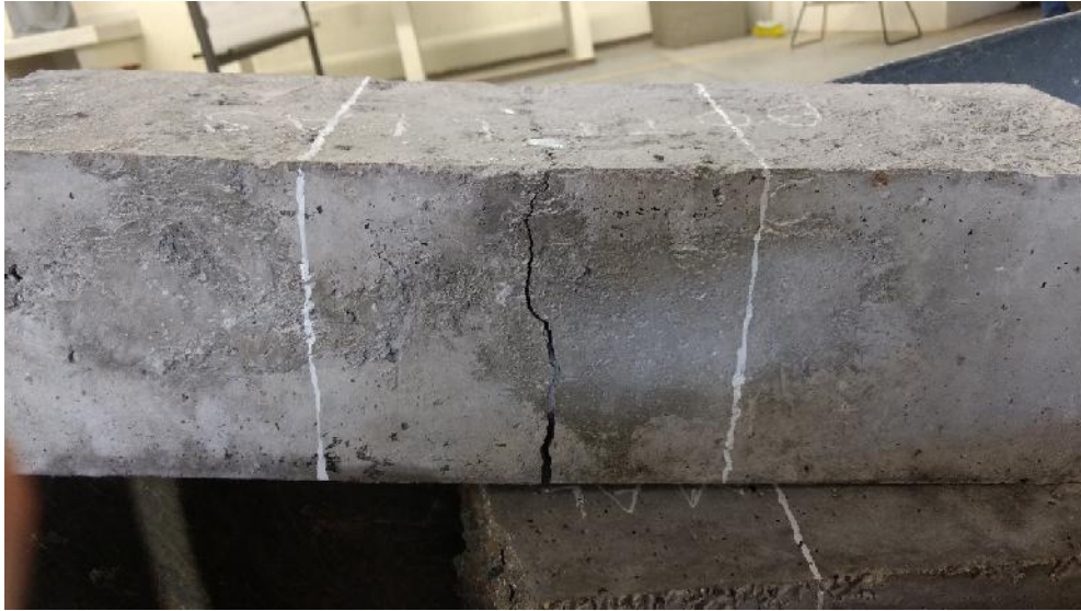
Ilustración 40. Falla lateral de viga con botella
