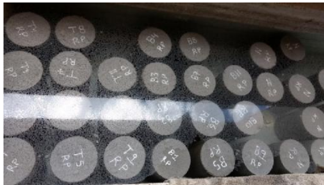
Acopio para tiempo de curado hasta la altura completa de los cilindros
