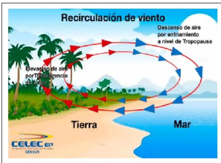
Figura 1. Recirculación de viento
