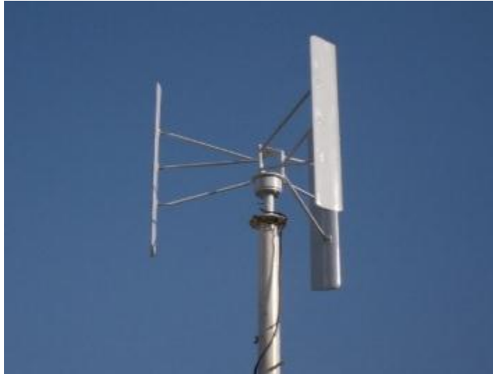
Figura 8. Rotor Darrieus tipo H
