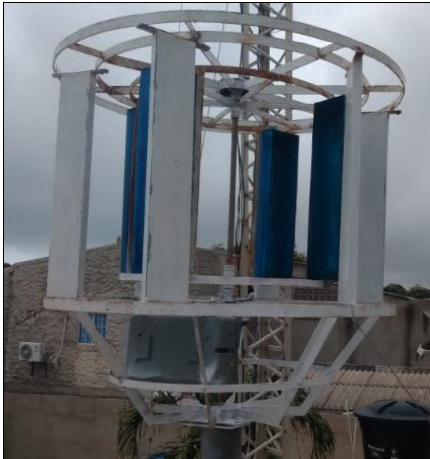
Figura 29. Estructura del aerogenerador
