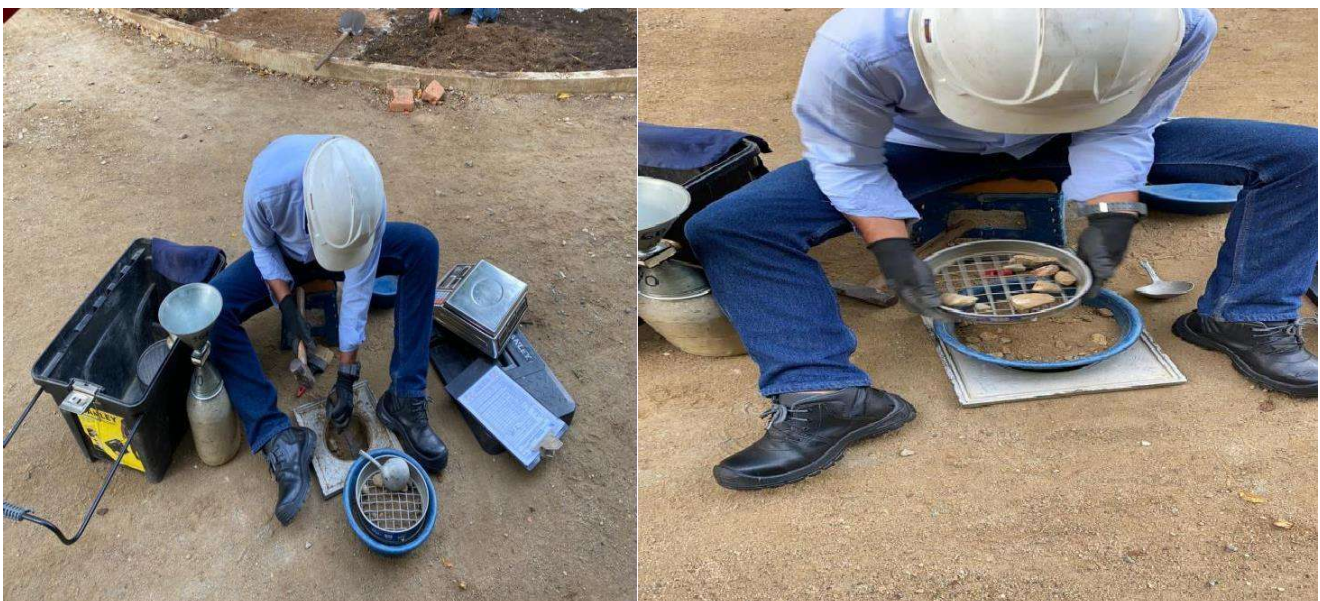
Figura 20. Ensayo de densidad
