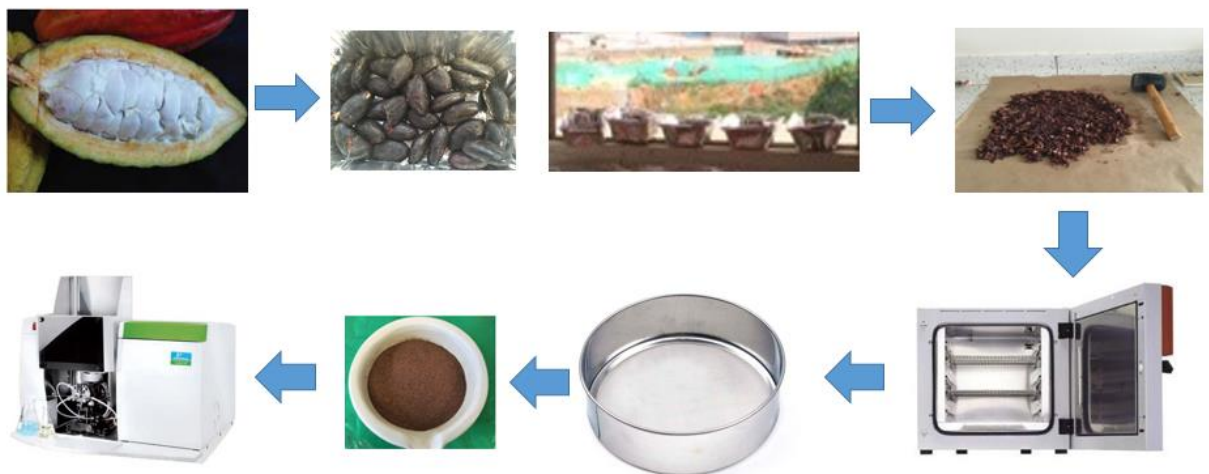
Figura 12. Proceso de la preparación de la muestra de la almendra fresca para análisis de cadmio por medio de absorción atómica.
