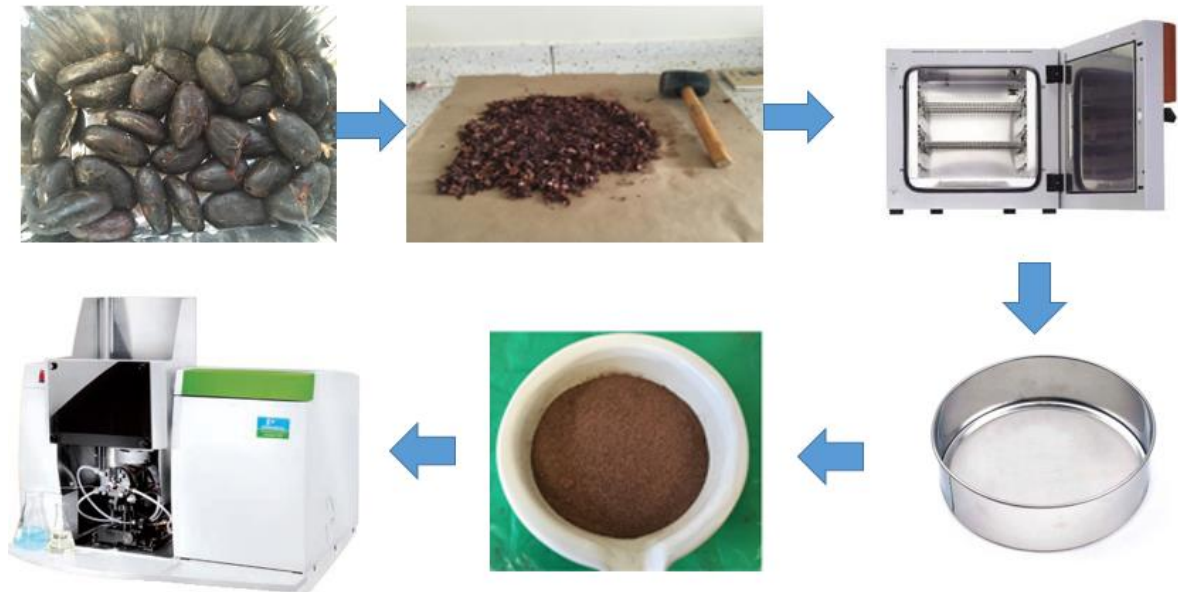
Figura 11. Proceso de la preparación de la muestra de la almendra seca para análisis de cadmio por medio de absorción atómica.
