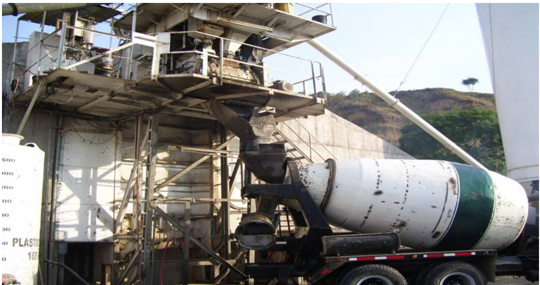
Figura 10. Concreto Listo vaciado en la Mixer.
