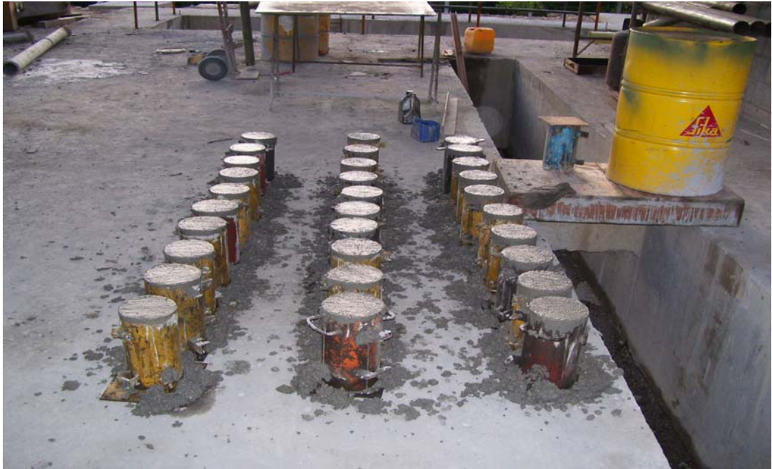
Figura 15. Muestras de cilindros de concreto.
