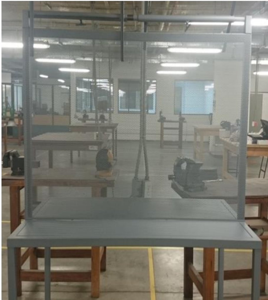
Figura 55. Estructura pintada con anticorrosivo gris.
