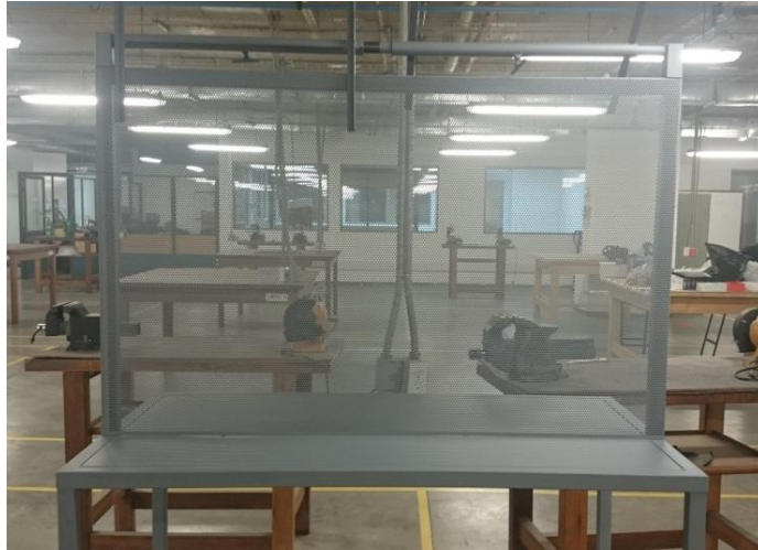
Figura 51. Estructura de acero cold rolled o acero 1018
