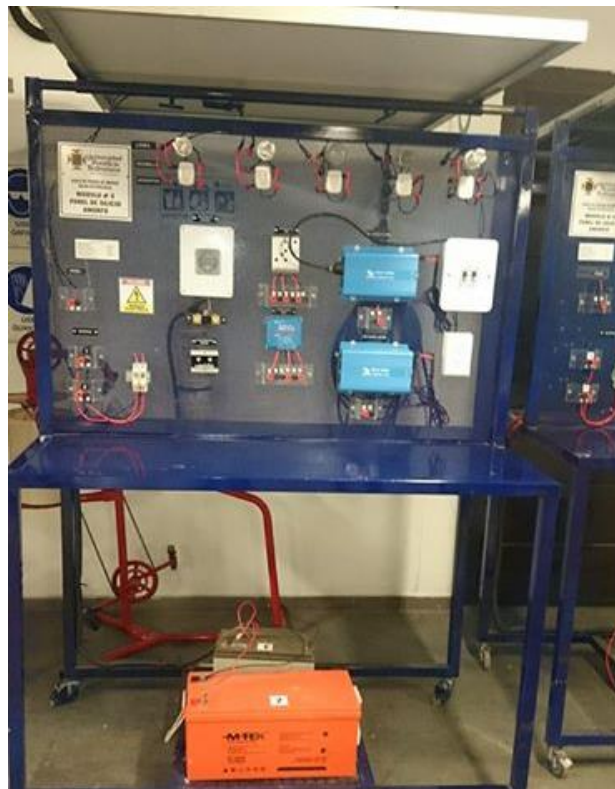
Figura 52. Banco de prueba de energía solar fotovoltaica, Modulo No.4: Panel de silicio amorfo.
