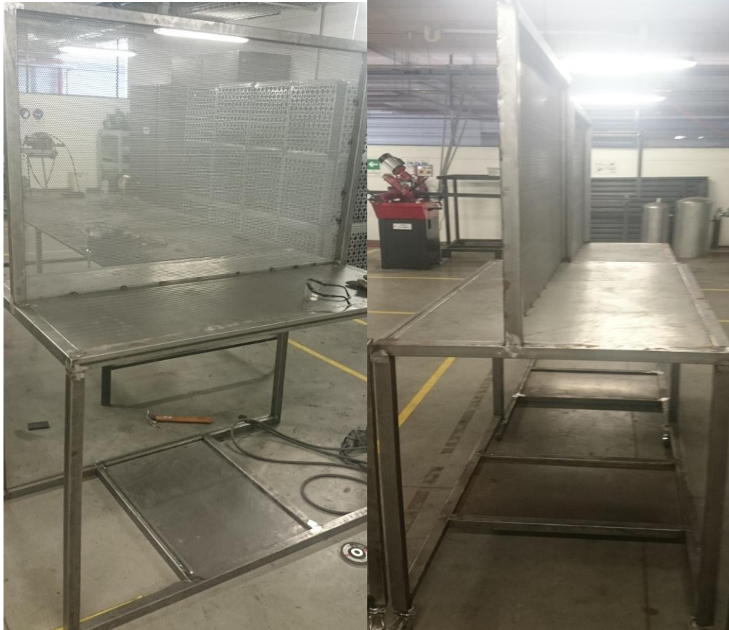
Figura 54. Estructura con láminas cold rolled soldadas
