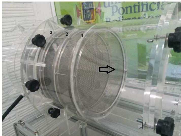
Foto 10. Ubicación enderezador de flujo zona de descarga.
