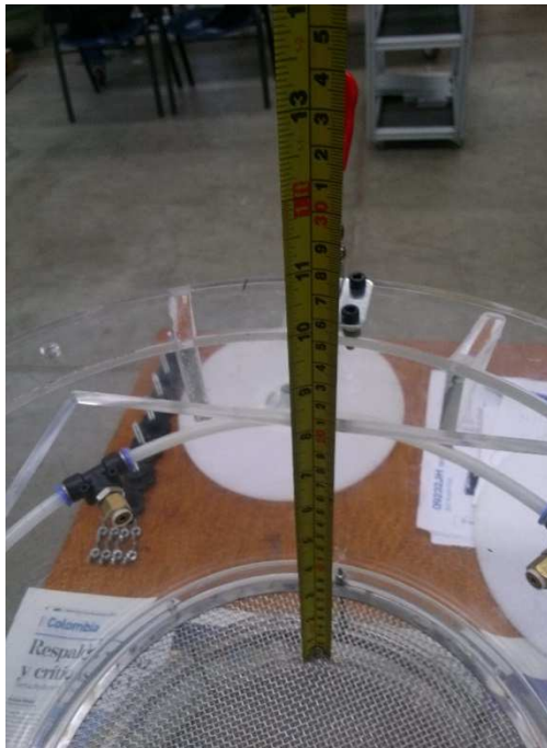
Foto 6. Distancia entre el área de admisión y el enderezador de flujo.
