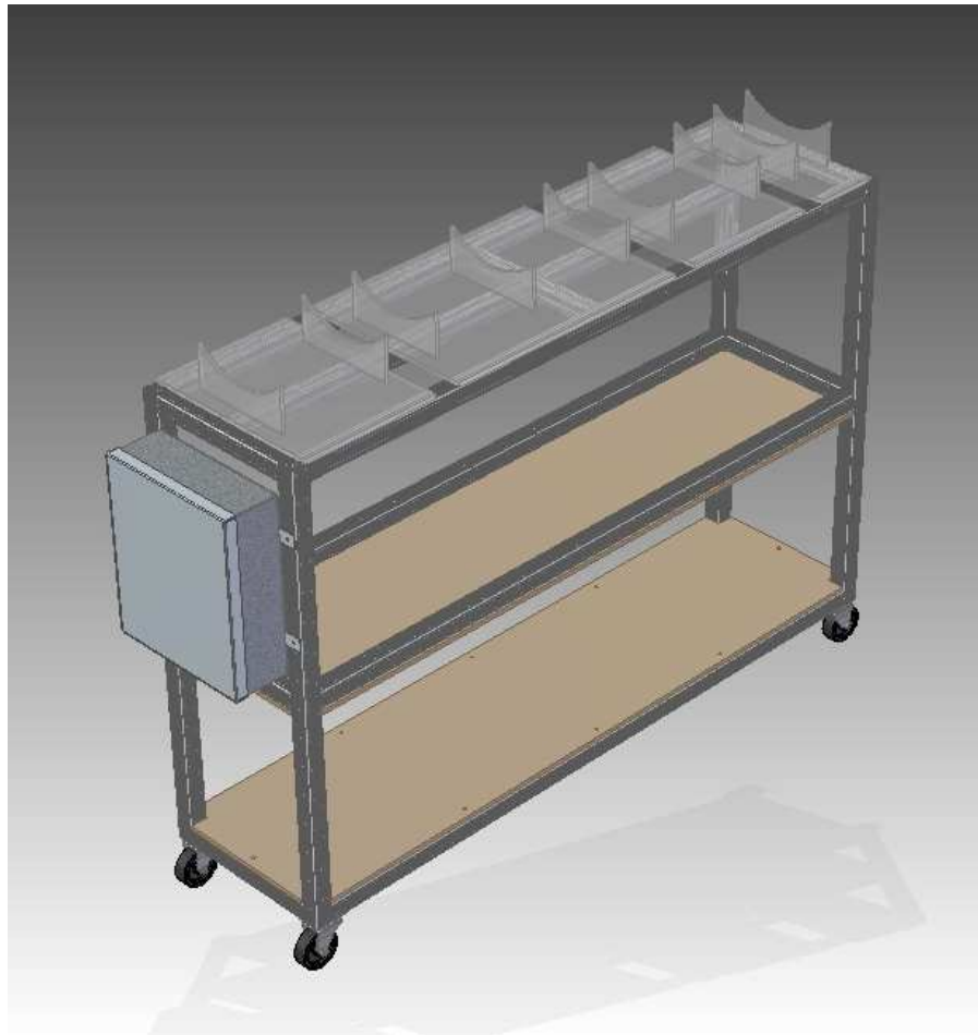
Figura 27. Estructura Soporte Túnel de viento.
