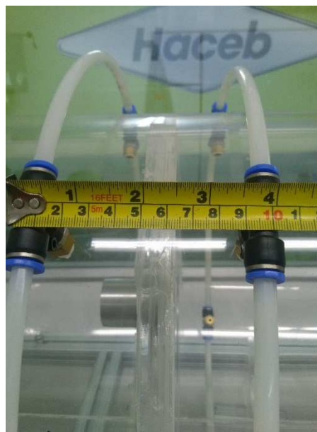
Foto 8. Distancia entre planos de medición de presión diferencial.
