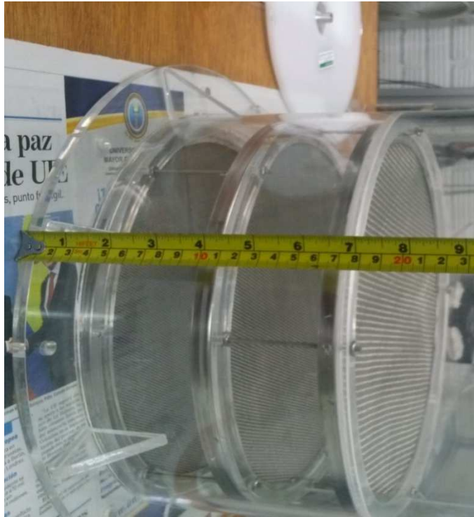
Foto 1. Distancia mínima entre mallas del Enderezador de flujo.
