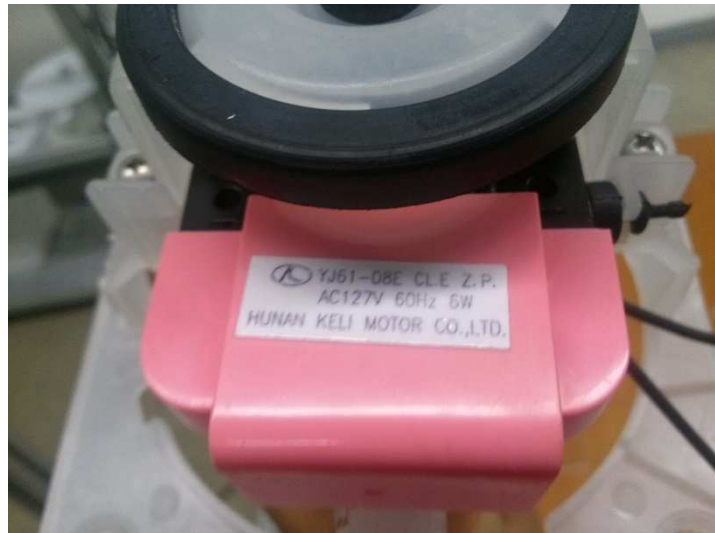
Foto 19. Datos de placa moto Ventilador Axial AC 1-6W.
