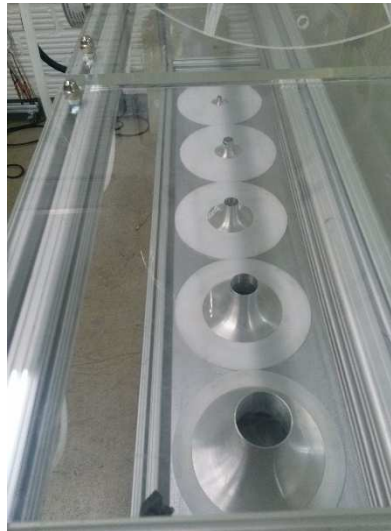
Foto 4. Estructura soporte, Segundo nivel, ubicación de los Nozzles.
