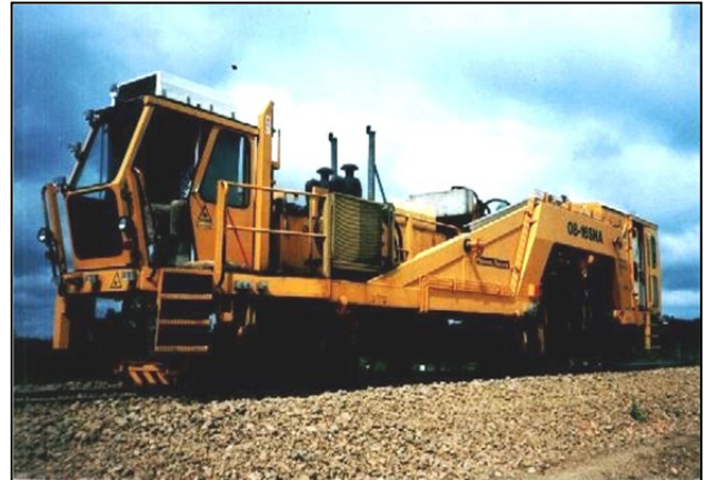
Imagen 69. Bateadora de mira láser utilizada en el proyecto.
