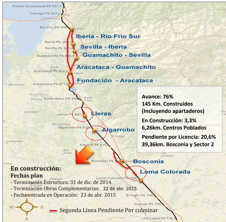
Figura 16. Esquema del avance de las obras
