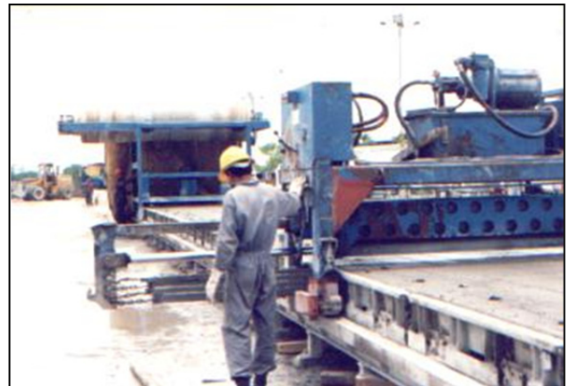
Imagen 20. Retiro de las platinas separadoras de las traviesas después del fraguado inicial
