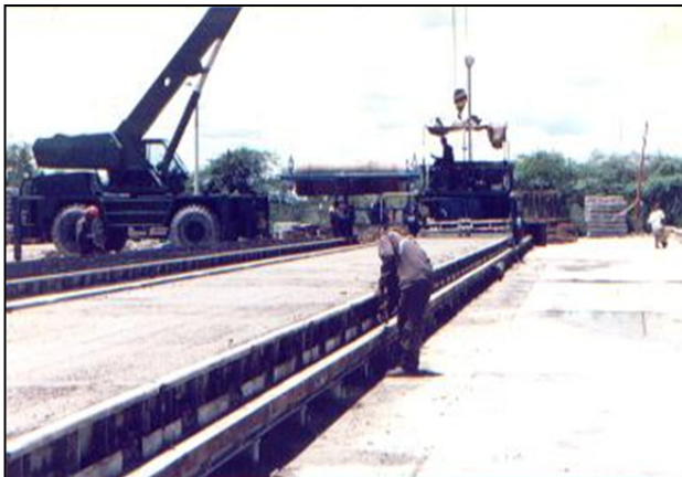
Imagen 19. Rotación del eje de resortes para liberar los hombros embebidos en la traviesa
