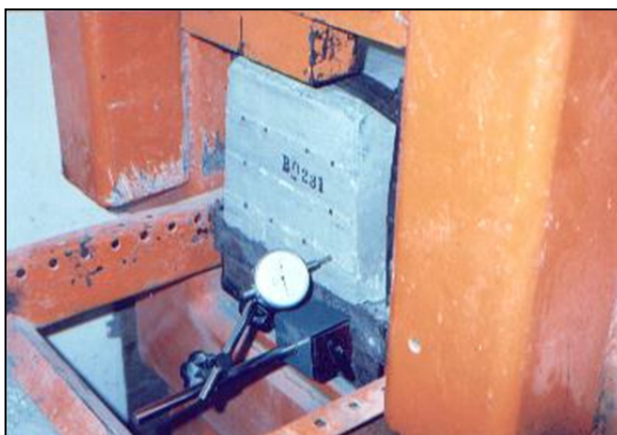
Imagen 33. Ensayo especial de anclaje de los alambres (micrómetro de 0.0001" - Normas AREA)
