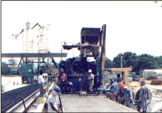
Imagen 19. Rotación del eje de resortes para liberar los hombros embebidos en la traviesa
