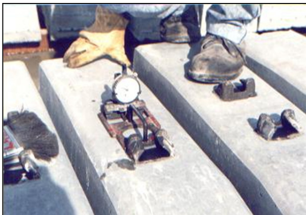
Imagen 31. Ensayo dimensional del hombro embebido, o torcido, tolerancia 1,0 mm para mayor o menor (especificación del proveedor de fijaciones)
