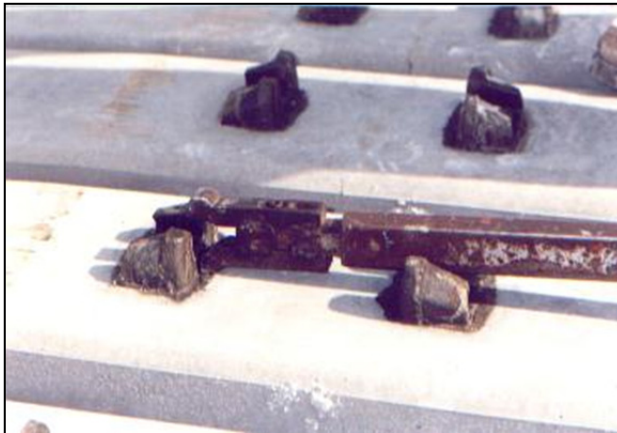
Imagen 31. Ensayo dimensional del hombro embebido, o torcido, tolerancia 1,0 mm para mayor o menor (especificación del proveedor de fijaciones)
