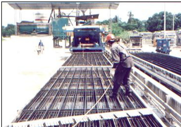
Imagen 15. Colocación de platinas separadoras horizontales y verticales para garantizar posición correcta de los alambres
