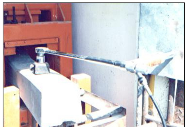
Imagen 34. Ensayo especial con traviesas (resistencia a torsión de los hombros embebidos con llave hidráulica de torque - Normas AREA)
