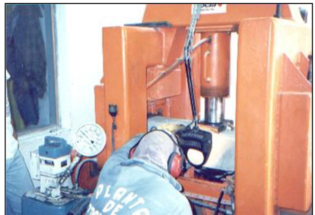
Imagen 34. Ensayo especial con traviesas (resistencia a torsión de los hombros embebidos con llave hidráulica de torque - Normas AREA)
