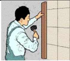
Figura 55. Verticalidad de las hiladas de enchape
