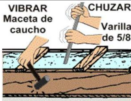
Figura 19. Fundida de la viga
