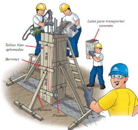
Figura 80. Colocación del encofrado de la columna
