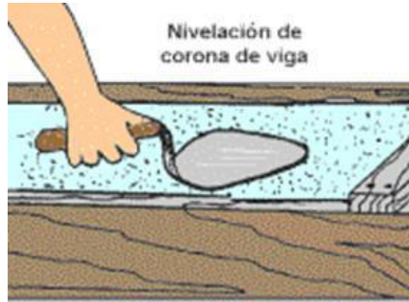
Figura 75. Nivelar corona de la viga
