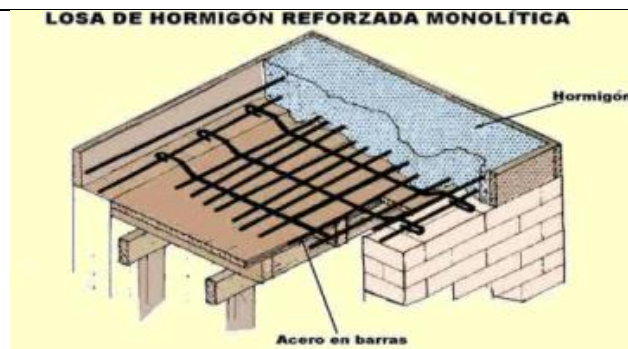
Figura 27. Losas de concreto fundidas monolíticamente
