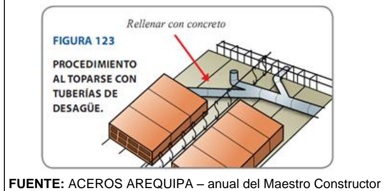
Figura 86. Colocación de tuberías de desagües
