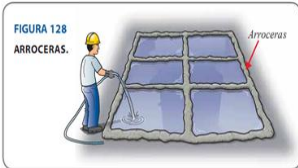
Figura 76. Desencofrado y curado
