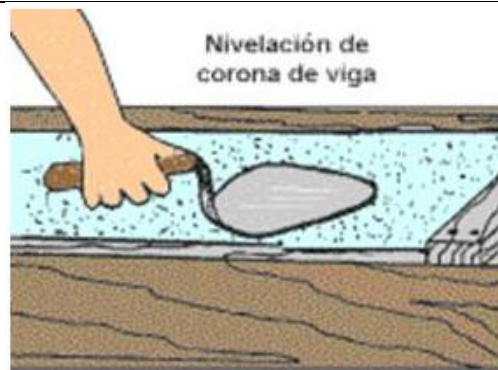
Figura 20. Nivelar corona de la viga
