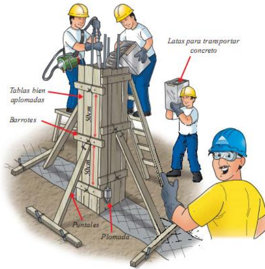
Figura 25. Vaciado y vibrado de concreto
