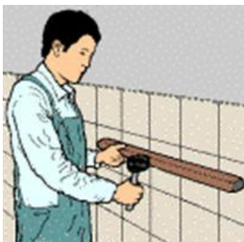
Figura 56. Planitud de las hiladas de enchape
