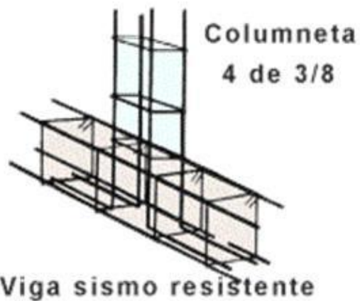
Figura 70. Armar la canasta para la viga y la columna
