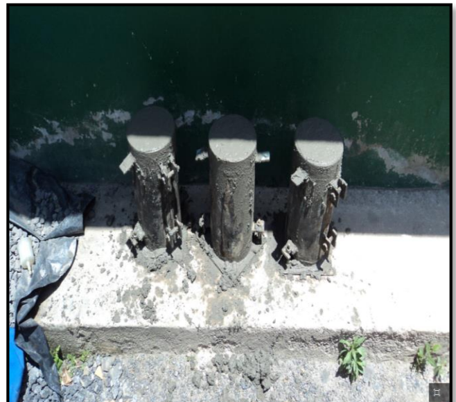
Figura 89: muestras de concreto 4000 psi
