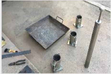
Fotografía 9. Equipo de compactación
