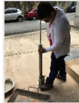
Fotografía 12. Compactación del suelo (Método A)
