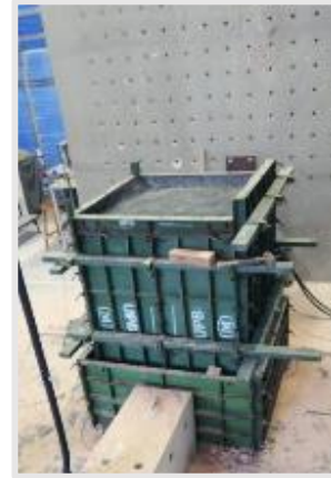
Fotografía 22. Modulación de formaleta para el suelo de fundación como el prototipo a escala.
