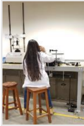
Fotografía 17. Toma de datos en máquina de corte directo
