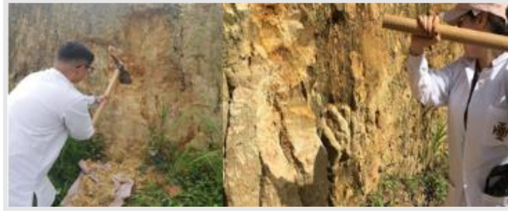
Fotografía 1. Extracción del suelo de fundación y de relleno
