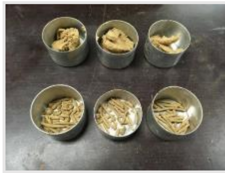
Fotografía 6. Toma de humedades
