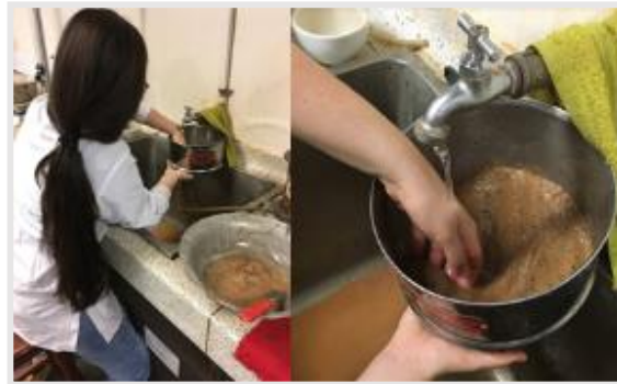
Fotografía 2. Lavado granulométrico por la malla No. 200
