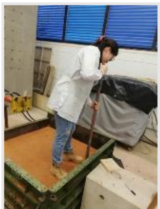
Fotografía 25. Compactación del suelo de fundación
