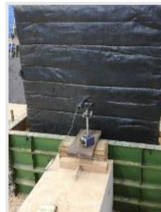
Fotografía 30. Nivelación y ajuste del deformímetro
