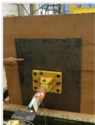
Fotografía 31. Implementación y alineación de platina metálica
