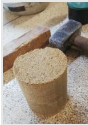
Fotografía 15. Espécimen preparado en molde proctor modificado
