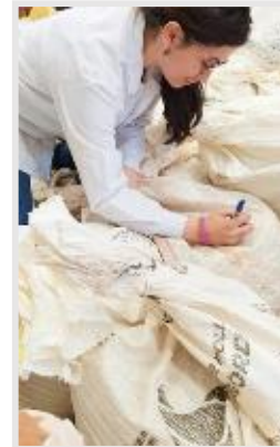
Fotografía 20. Toma de humedades naturales para estimación de la humedad óptima de compactación
