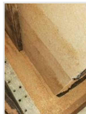
Fotografía 32. Falla por deslizamiento
