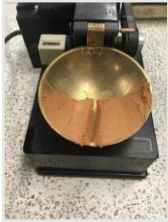
Fotografía 4. Prueba de limite liquido
