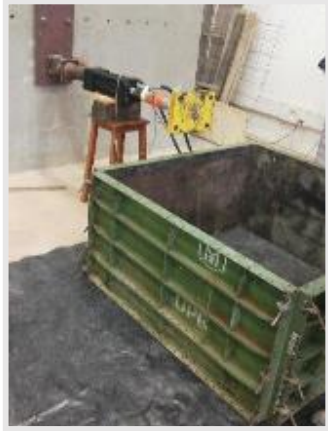
Fotografía 21. Modulación de la formaleta para el suelo de fundación.
