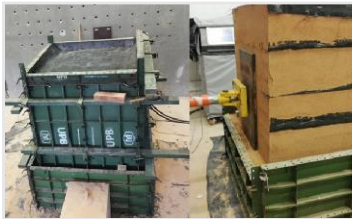
Figura 17. Modulación y compactación del suelo de relleno Fuente: Elaboración propia.
