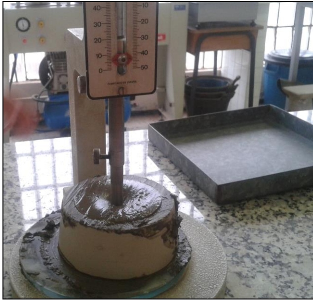
Fotografía 9. Test de tiempo de fraguado al concreto Fuente: Elaboración propia
