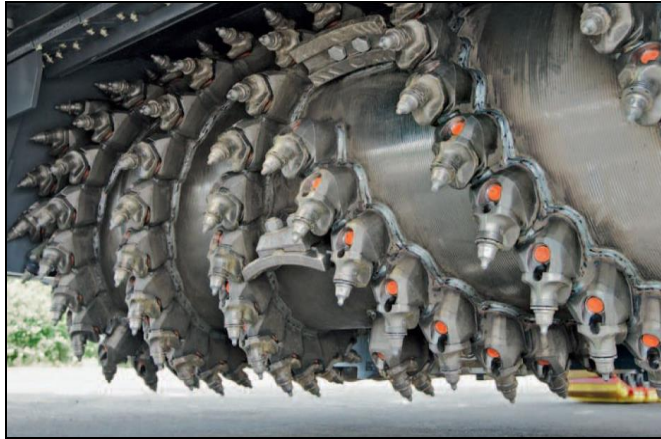
Fotografía 6. Tambor-desbastador giratorio fresadora W-1500 Fuente: WIRTGEN GROUP, Alemania (2016)
