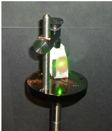
Figura 8. Haz de luz láser verde incidendo en una muestra de hematita.
