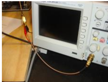
Figura 14. Conexión de la salida del preamplificador con el osciloscopio.
