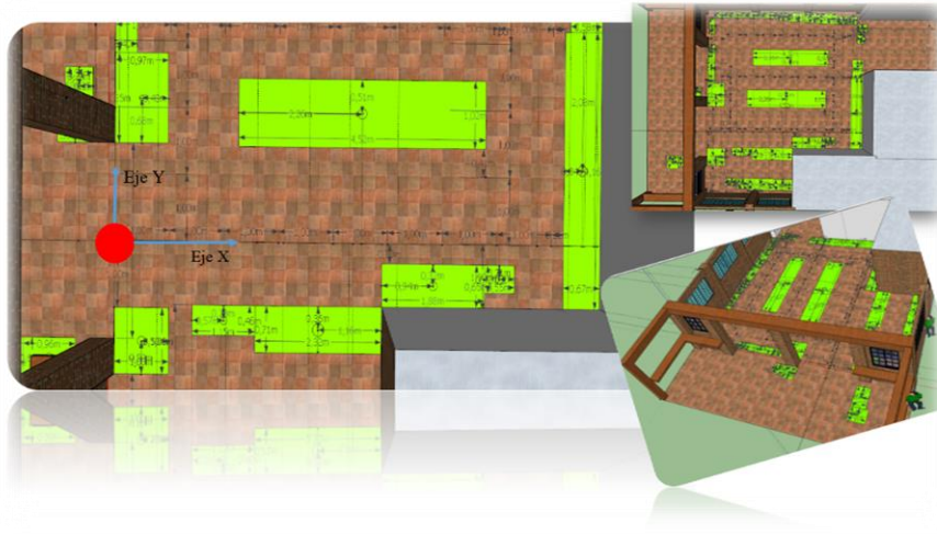
Ilustración 13. Propuesta 3. Coordenadas (x, y) para el cálculo del flujo recorrido desde el punto inicial a cada equipo.
