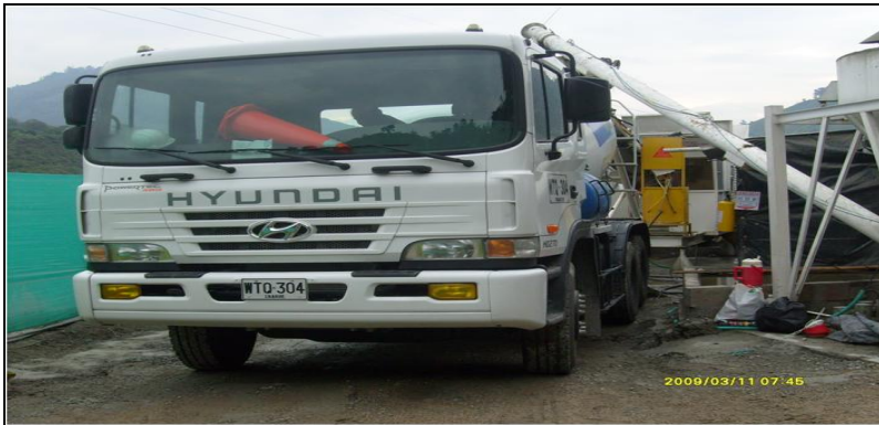
Foto 15. Mixer para Transporte en Obra de Mezcla de Concreto.
