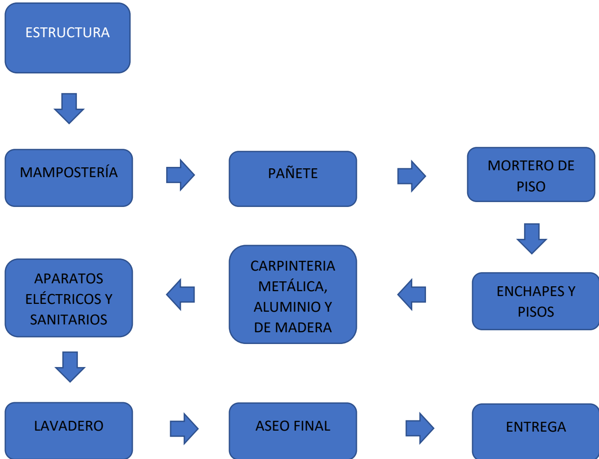
Figura 6-2 Secuencia constructiva de apartamentos - Obra VENTURA [Fuente propia].
