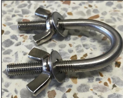
Figura 50. Accesorios para fijar las Te Swagelok a la estructura del modulo
