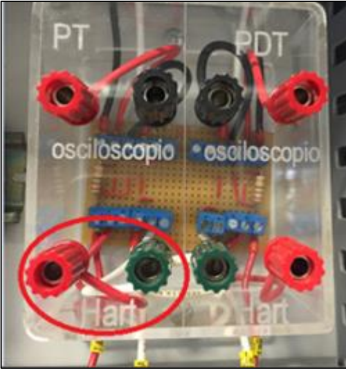
Figura 93. Lugar de conexión de los terminales del configurador HART para los transmisores de presión
