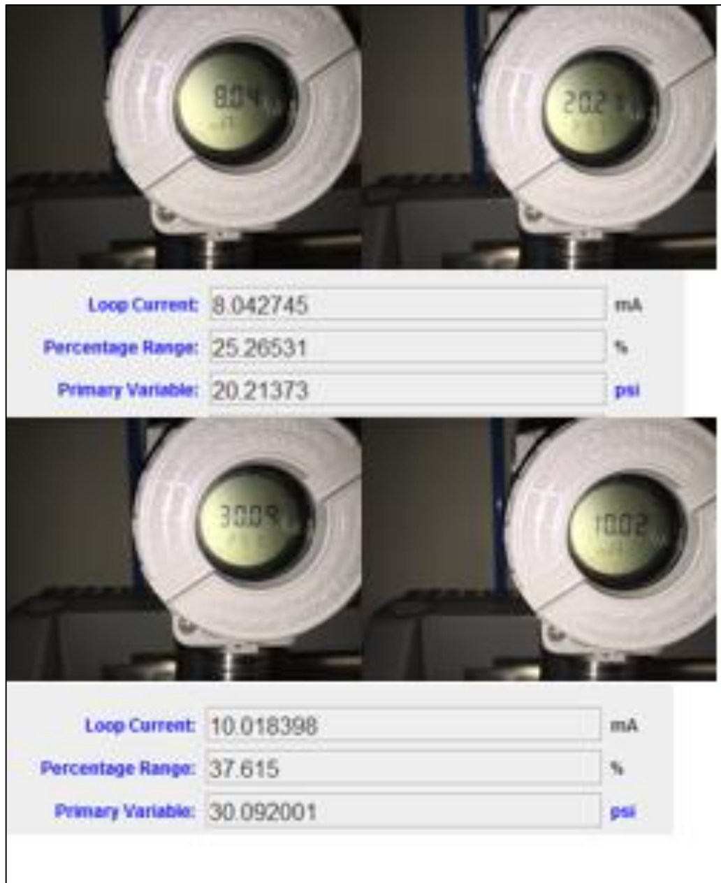
Figura 68. Presión y corriente Indicadas por el software DDCON100 para el transmisor de presión relativa
