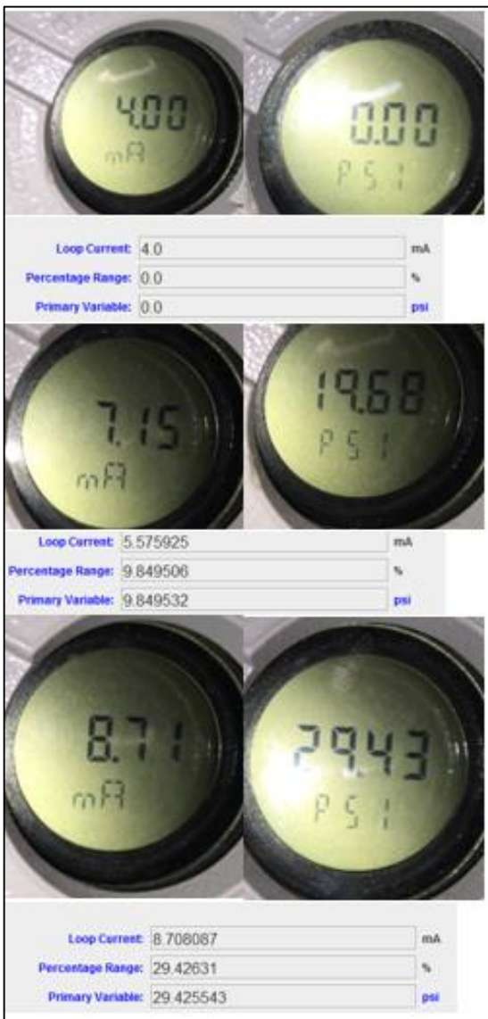
Figura 69. Presión y corriente Indicadas por el software DDCON100 para el transmisor de presión diferencial
