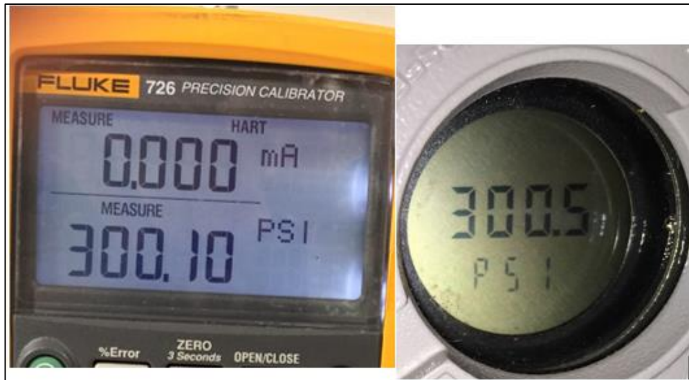
Figura 72. Lectura de la presión del módulo de presión FLUKE y el transmisor de presión relativa
