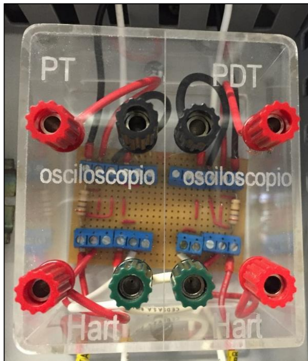
Figura 60. Caja para conectar los terminales del configurador HART y osciloscopio
