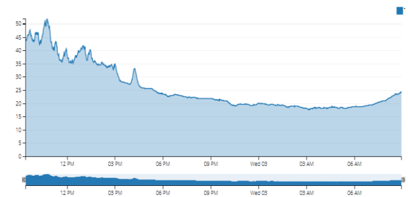
Fig. 7. Registro de temperatura sobre los paneles de la entrada peatonal.
