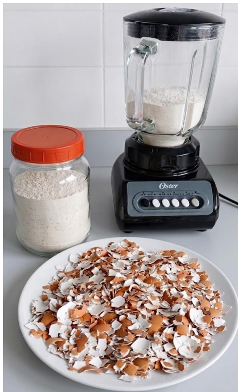
Figura 2. Proceso de molienda de la cáscara de huevo
