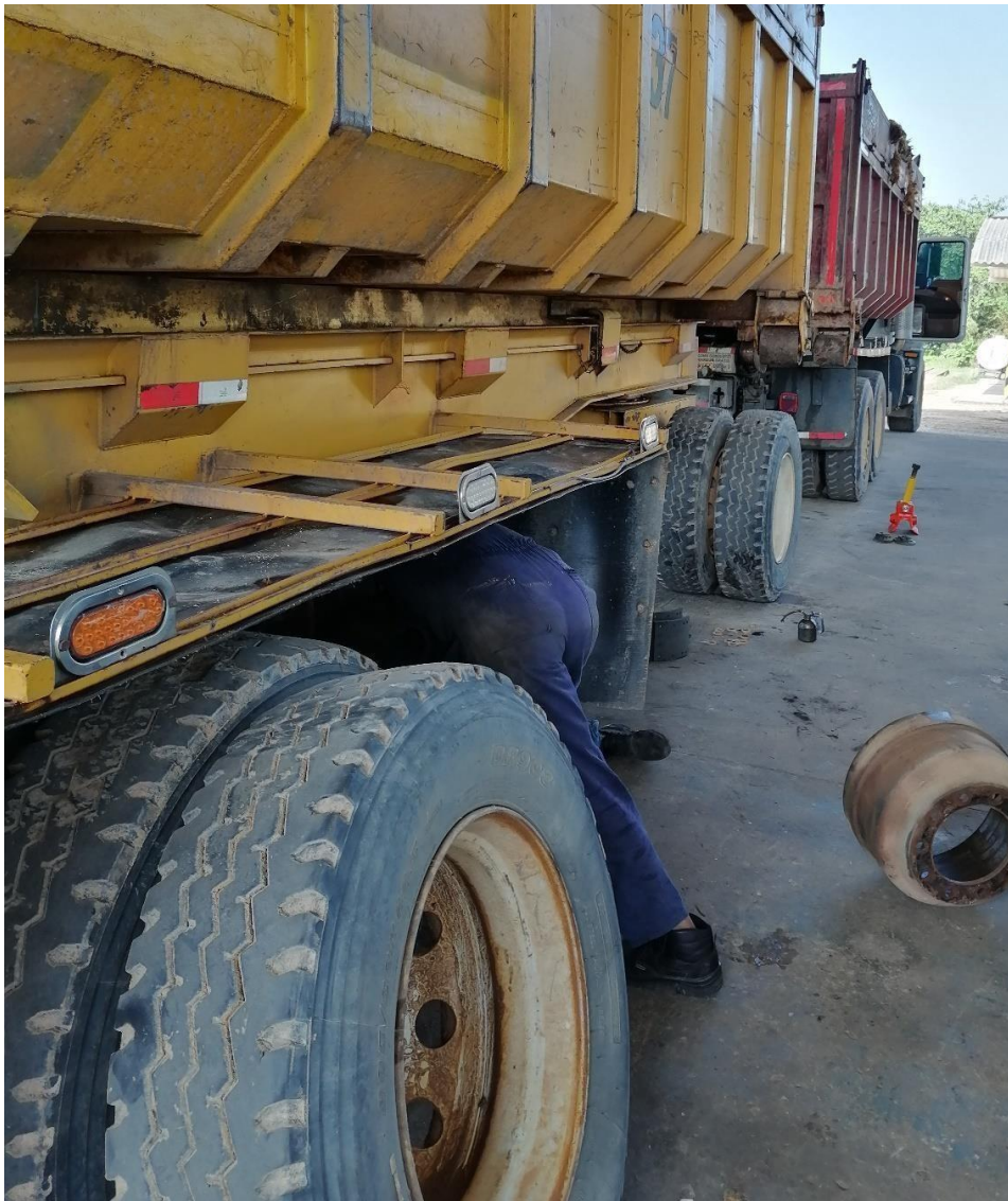
Fig. 42 Remolque listo para desmontaje de llantas.
