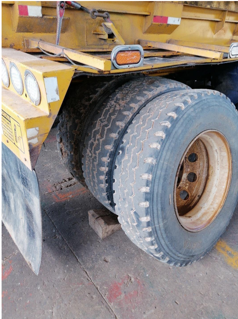
Fig. 41 Llantas listas para cambio, en proceso de desmontaje.
