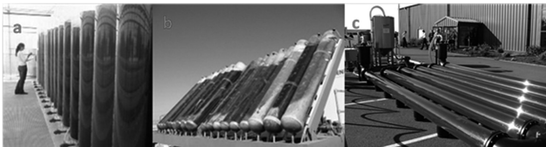
Figura 7. Fotobiorreactores tubulares (a: verticales, b: inclinados, c: horizontales)
