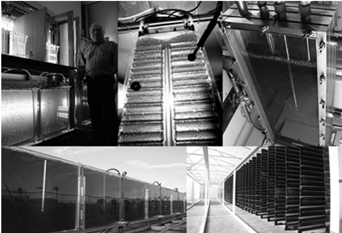
Figura 9. Reactores cerrados tipo panel
