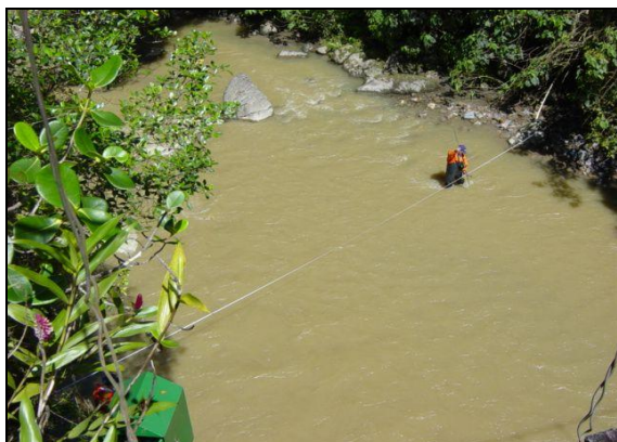
Figura 8-1 Aforo con molinete en la estación San Luis, ubicada sobre el río Guatiquía. Fuente EAAB.
