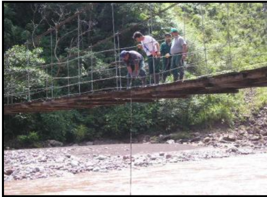
Figura 4-6 Aforo por suspensión desde Puentes. Fuente: EAAB.
