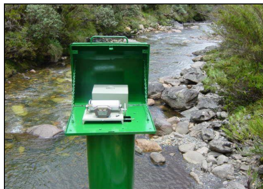
Figura 6-2. Limnógrafo Estación San José, ubicada sobre el río Guatiquía. Fuente EAAB.
