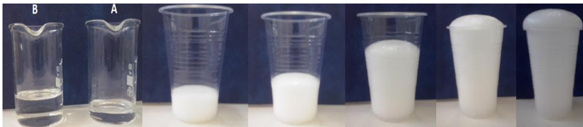
Figura 17. Componentes adicionados para la obtención de espumas de poliuretano.
