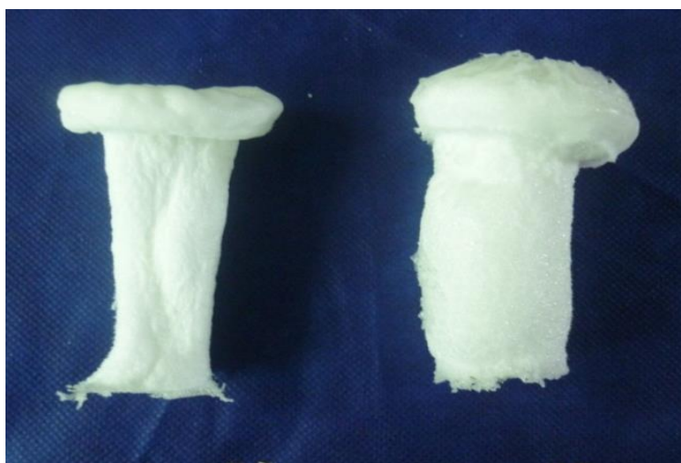
Figura 18. Colapso de las espumas por efecto del catalizador de estaño y de amina.
