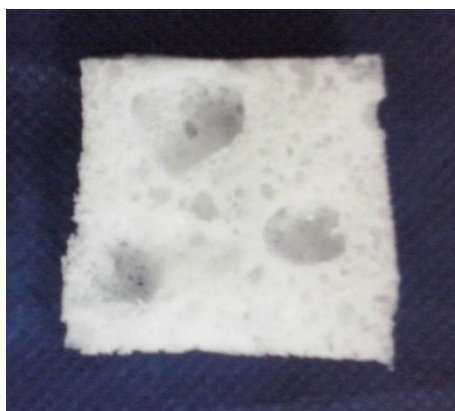
Figura 20. Efecto de la silicona en el tamaño de los poros de la espuma de poliuretano.
