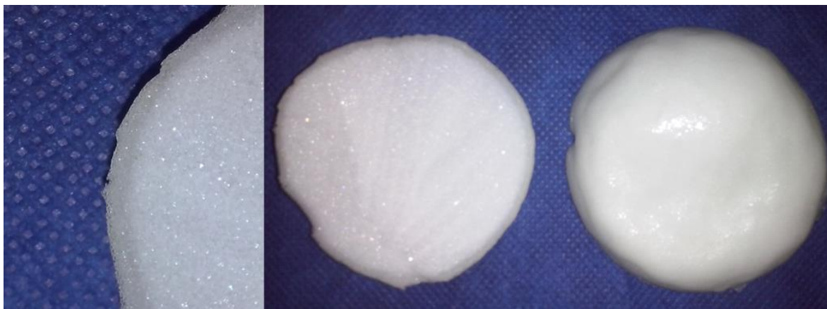
Figura 19. Efecto de la silicona en la piel de la espuma de poliuretano
