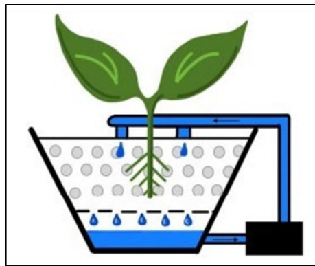
Ilustración 2. Sistema de riego con recirculación
