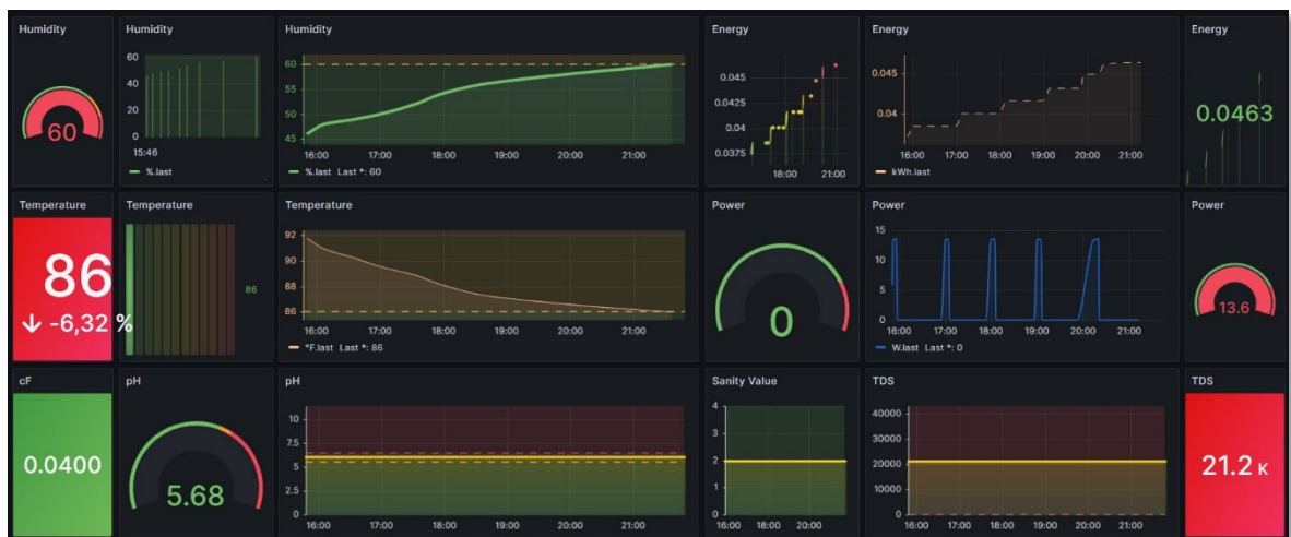
Ilustración 26. Panel de monitorización implementado en Grafana (humedad, temperatura, pH, cF, TDS, energía y potencia)
