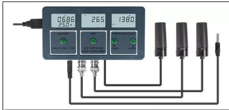
Ilustración 6. Diagrama puertos medidor multiparámetros
