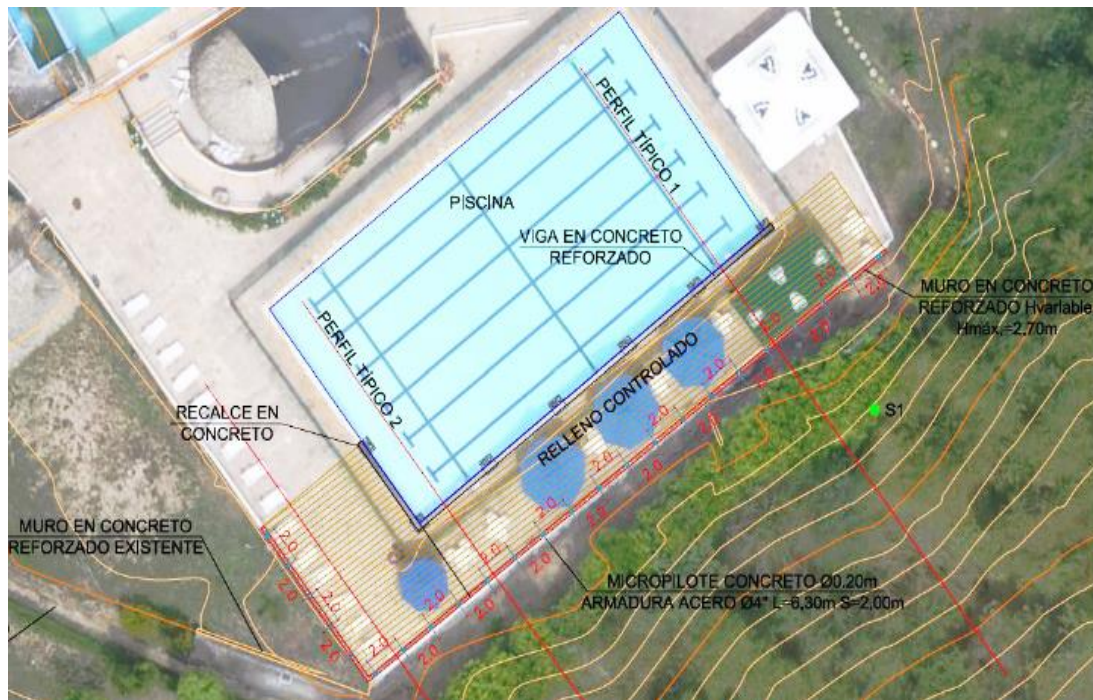
Ilustración 2. Localización estabilización Piscina Semi Olímpica, Club Lomas del Viento. (Fuente: E.D. Ingeotecnia S.A.S)
