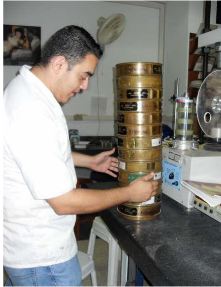
Fig. 4. Tamizado de cada una de las muestras.
