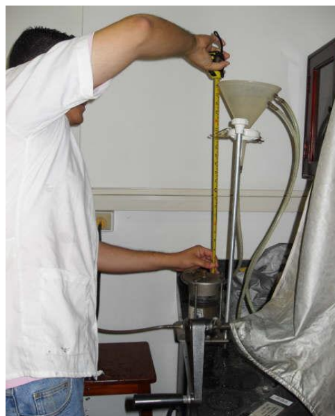
Fig.23. Se toma la altura de la cabeza de agua ( h ).
