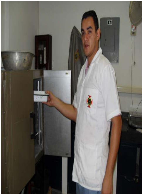
Fig.12. Se introduce la cápsula al horno a una temperatura de 110^{\circ}\text{C} preferiblemente por 18 horas.
