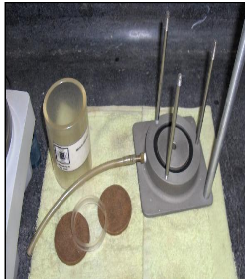
Fig.17. Se pesan todos los elementos del permeámetro y se adjuntan estos datos en el formato utilizado.
