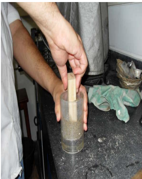
Fig.20. Se enraza la muestra dentro de la cápsula del permeámetro para lograr una buena uniformidad.
