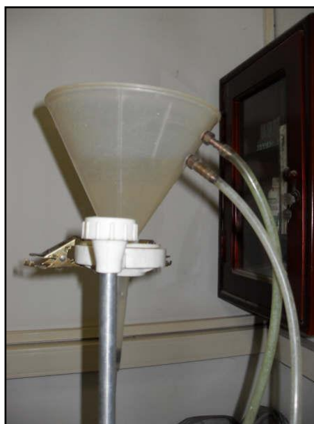
Fig.21. Se estandariza el flujo de agua que entra al cono del permeámetro, para asegurar una mejor investigación.
