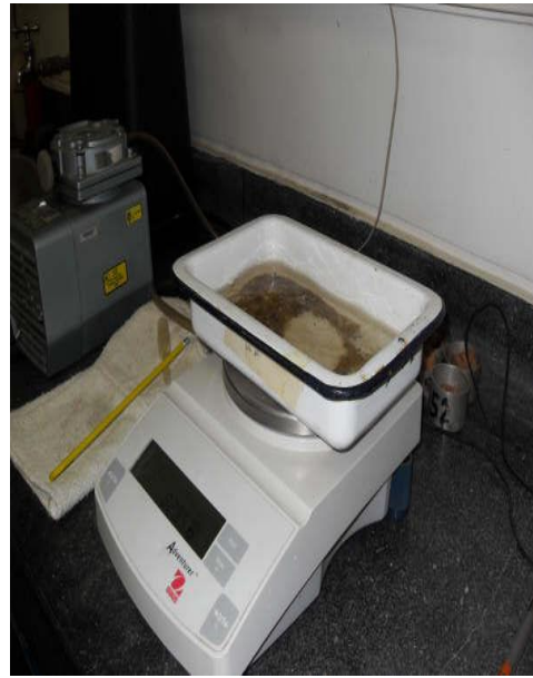
Fig.11. Peso de la muestra previo conocimiento del peso de la capsula.
