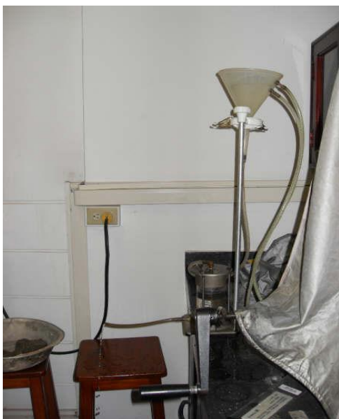
Fig.22. Permeámetro, con flujo constante funcionando correctamente.
