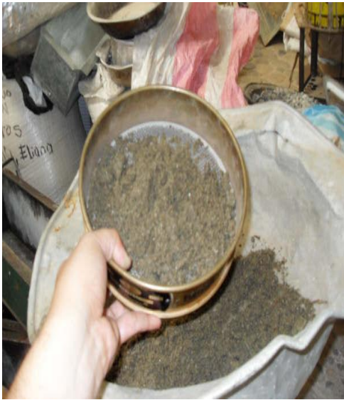
Fig.16. Se pasa la muestra por el tamiz numero 4.
