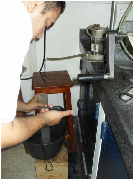
Fig.24. Se toma un caudal ( Q ) en un tiempo de 180 segundos.
