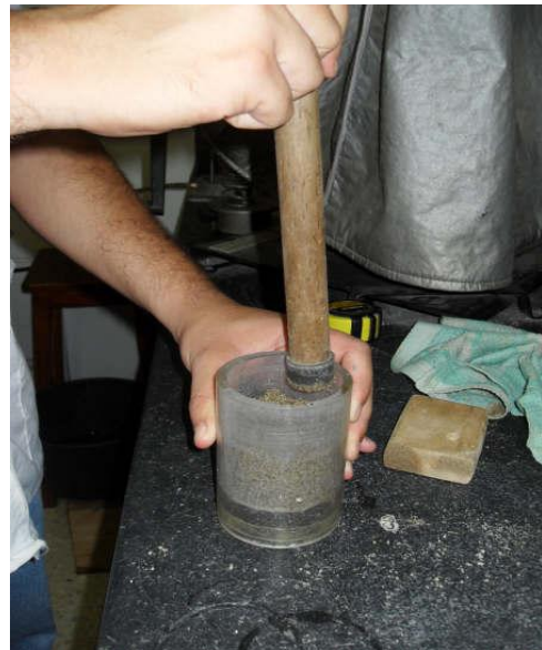
Fig.19. Se golpea la muestra para lograr una compactación continua y pareja.
