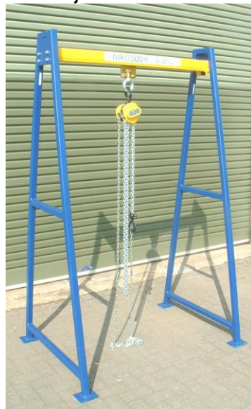
Imagen 47 Estructura metálica para sujeción de elementos (Burro izaje).
