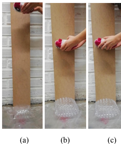
Figura 15. Altura de rotura en cada probeta, (a) Piramidal, (b) Cúbica, (c) Semiesférica.
