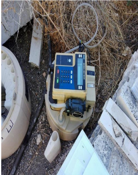
Figura 2. Toma muestras automático.
