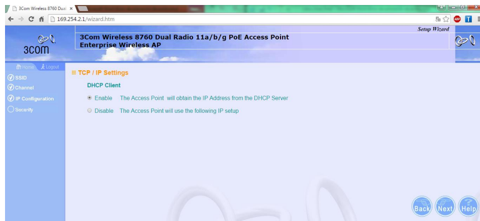
Figura 84. Interfaz Web TCP/IP Settings del Access Point 3Com.
