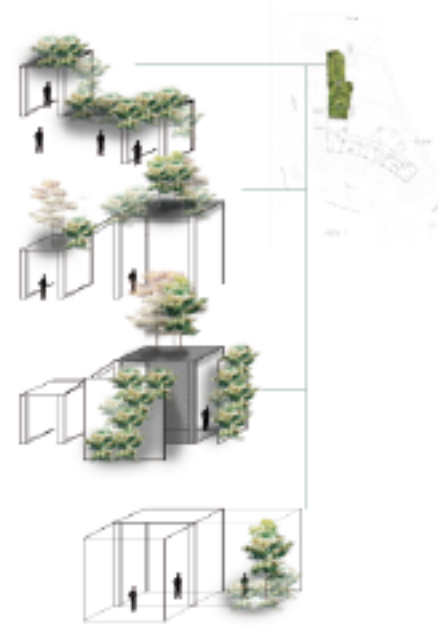
Diagramas de transformaciones que toma la intervención techo verde. Puede incluir una doble piel vertical que ayude a disminuir el ruido en las habitaciones del Hotel.
