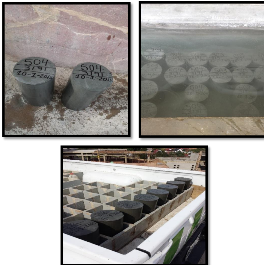
Figura 22. Identificación, Curado y Envío de Cilindros de Concreto.
