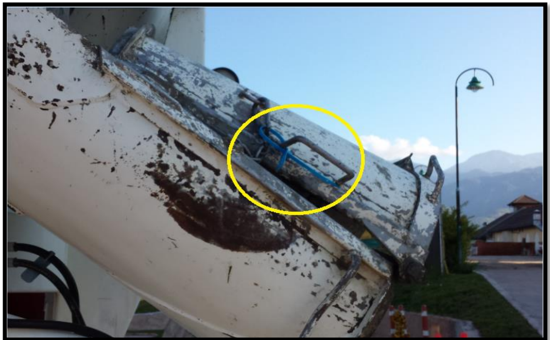
Figura 19. Verificación del sello en obra de la mixer.
