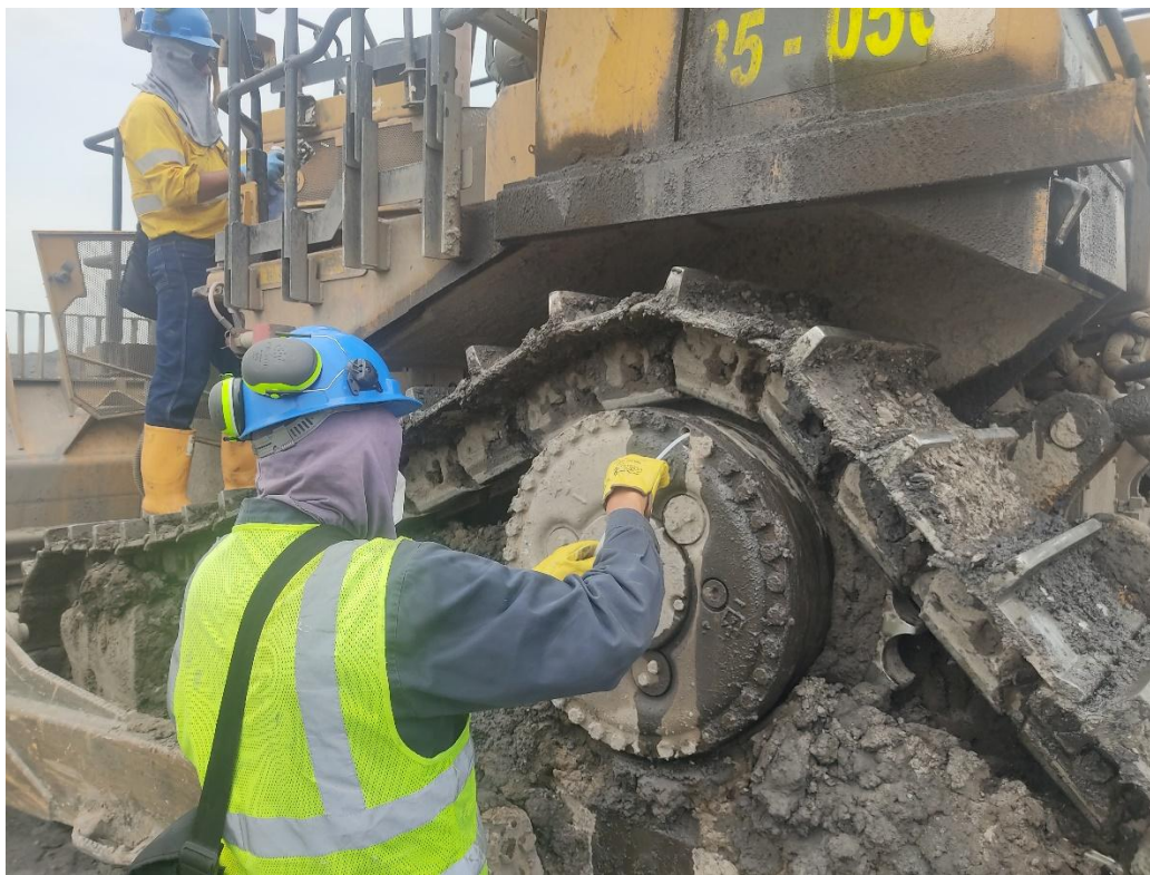
Fig. 10. Toma de muestra de aceite en campo
