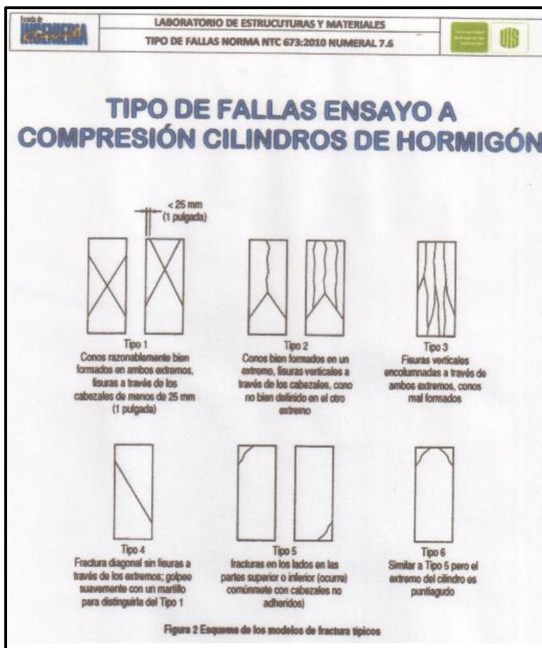
Ilustración 28. Tipos de fallas presentadas en las pruebas, fuente: (UIS, 2020)
