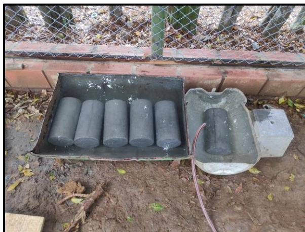
Ilustración 25. Preparación probetas de concreto, fuente: propia
