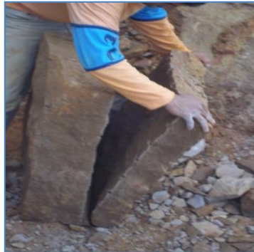
Figura 31. Fragmentación de los bloques
