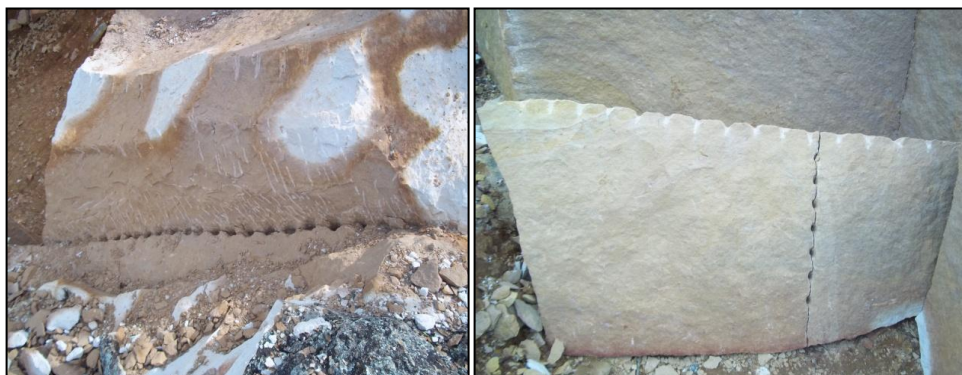
Figura 13. Método de fractura de la piedra
