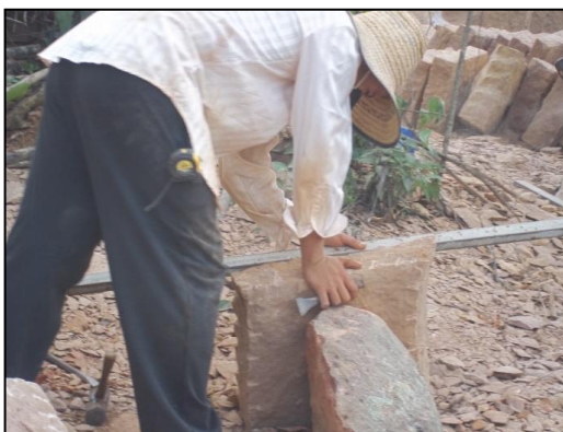
Figura 15. Cantero regulando losetas mediante el uso de sus herramientas
