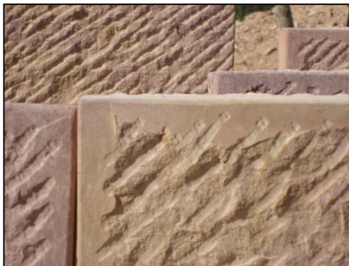
Figura 22. Acabado Biselado en los bordes
