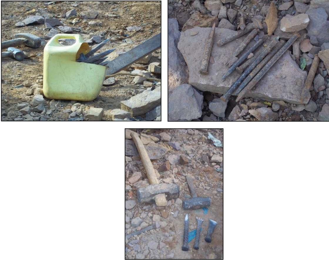
Figura 18. Herramientas para la extracción y talla de piedra
