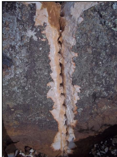
Figura 30. Fragmentación de la piedra para ser extraída por bloques
