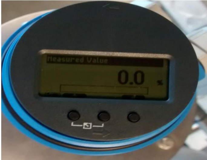
FIGURA 4-10: LECTURA DEL SENSOR LIQUICAP M FM151 TK-10B VACIO. FUENTE: AUTOR
