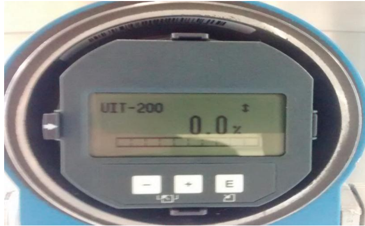
FIGURA 4-7: SENSOR DELTAPILOT M FMB50 TK-20 VACIO. FUENTE: AUTOR
