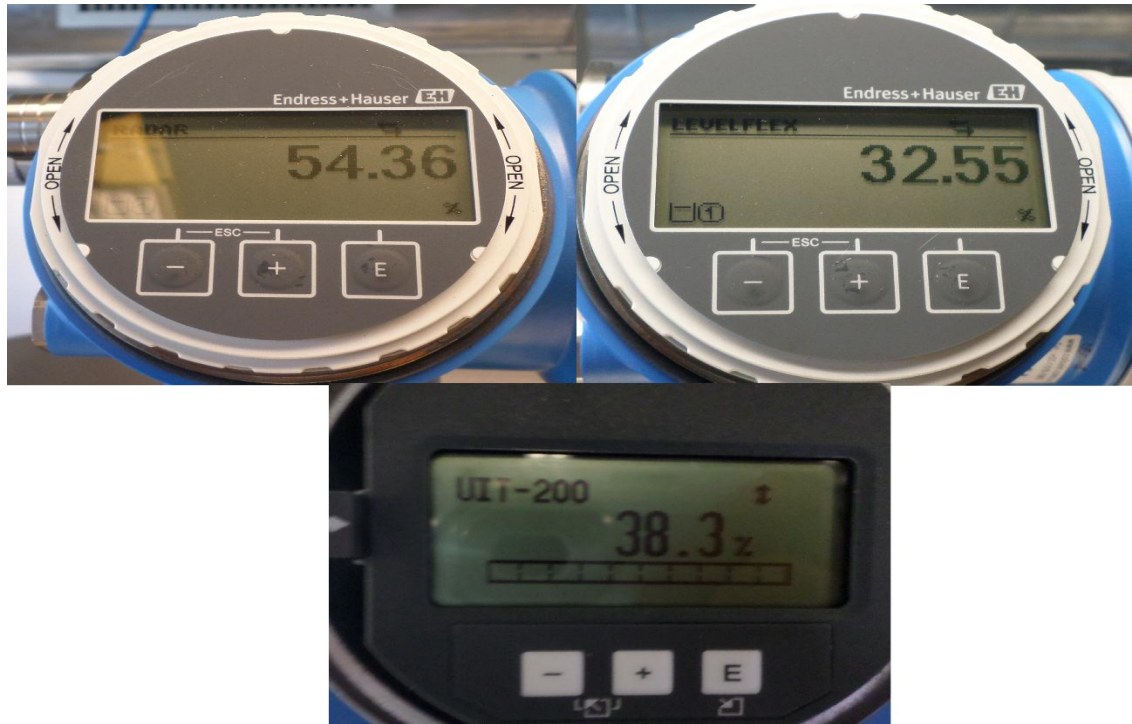
FIGURA 4-13: LECTURA EN PANTALLA DE LOS SENSORES EN LOS TANQUES TK-10A Y TK20 CON TURBULENCIA. FUENTE: AUTOR
