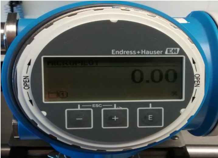
FIGURA 4-9: LECTURA DEL SENSOR MICROPILOT FMR51 TK-10A VACIO. FUENTE: AUTOR
