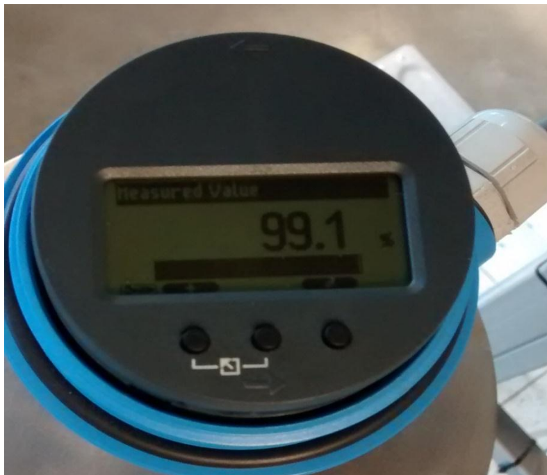
FIGURA 4-4: SENSOR LIQUICAP M FM151 TK-10B LLENO. FUENTE: AUTOR
