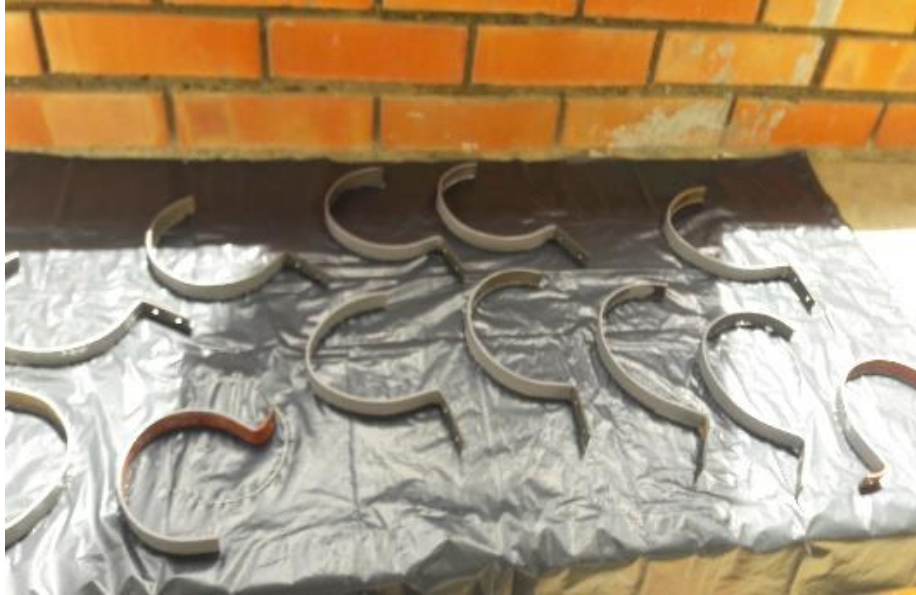
Ilustración 19. Abrazaderas pintadas de anticorrosivo. Fuente: Propia.
